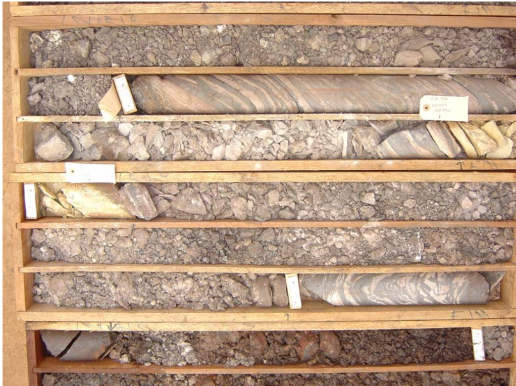
FOTO 2 - Testemunhos de sondagem
