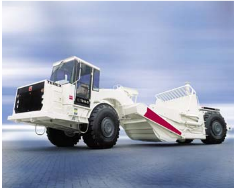
FOTO 4 – Equipamento de terraplanagem, Scraper.
