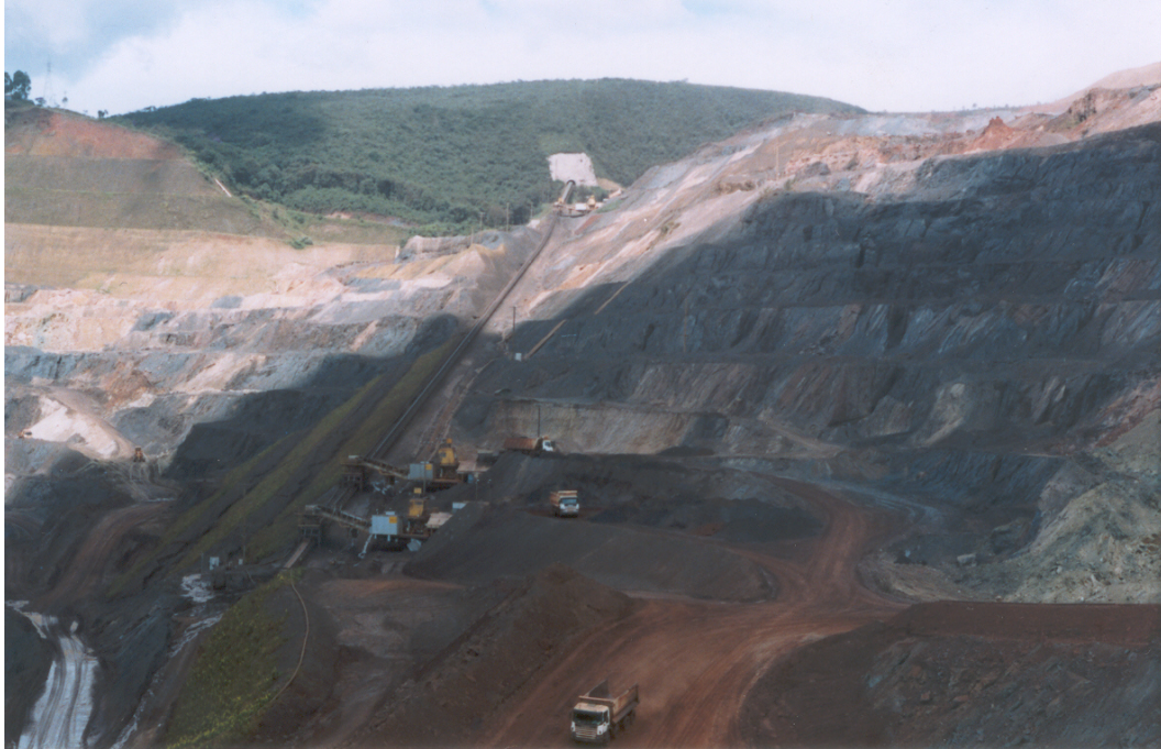
FOTO 17 – Britagem dentro da cava e caminhões de pequeno porte no minério
