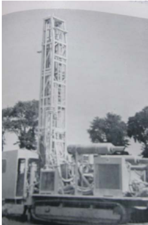
FOTO 5 – Perfuratriz a percussão para furos com 6 ½” de diâmetro
