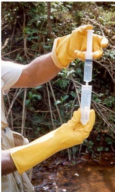
FOTO 4 – Coleta de amostra e armazenamento de água em tubo de polietileno graduado.
