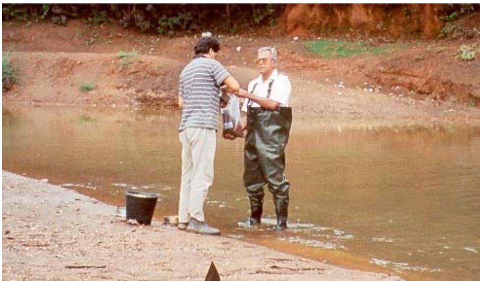
FOTO 6 – Coleta de amostra de sedimento de corrente no ribeirão da Prata
