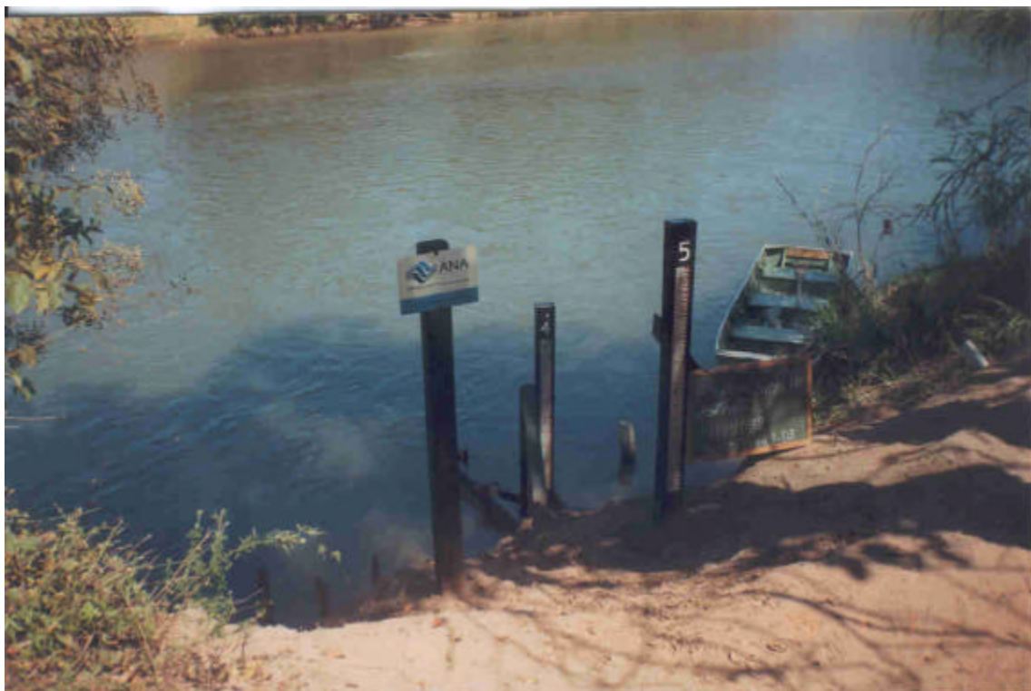
VISTA GERAL DOS LANCES DA SEÇÃO DE RÉGUA
