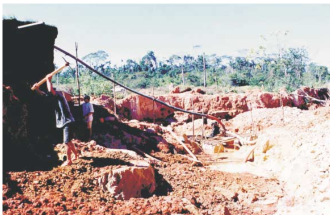
Fotografia 4.4 – Aspecto da lavra em latossolos e litossolos com desmonte manual e hidráulico desenvolvidos sobre os saprólitos dos granitóides da Suíte Nova Canaã.
