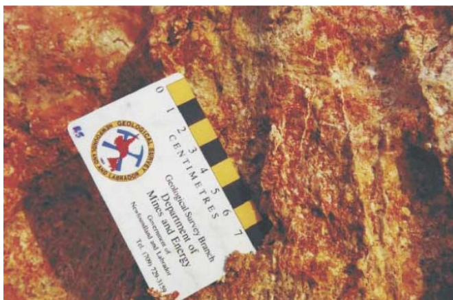
Fotografia 4.9 – Rede de vênulas de quartzo com Au tipo stockwork em saprólito de rocha vulcânica hidrotermalizada da Suíte Colíder. Garimpo dos Crentes, NNW de Paranaíta (CC- 179).
