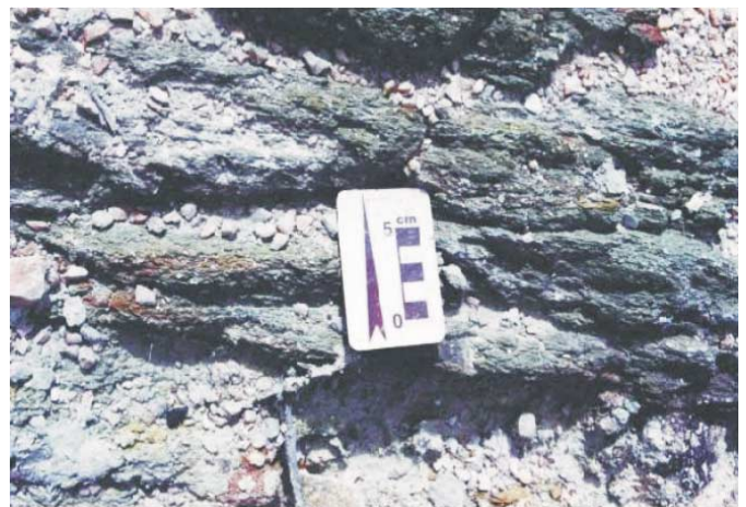
Fotografia 3.10 – Aspecto do filonito (quartzo + clorita + sericita) exibindo foliação milonítica e estruturas tipo "mica fish" (clorita-sericita), indicativas de uma zona de cisalhamento transcorrente sinistral (Falha do Cristalino). CC-290.
