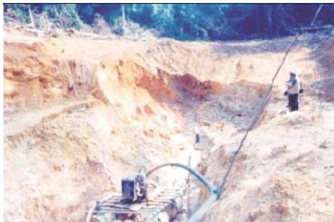
Fotografia 4.2 – Aspectos do desmonte hidráulico no saprólito com vênulas de quartzo multidirecionais (stockwork). Garimpo do Tião Fera (Novo Satélite).
