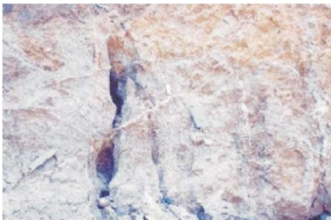
Fotografia 4.12 – Garimpo do Tião Fera, região do Novo Satélite. Saprólito com multivenulações tipo stockwork .
