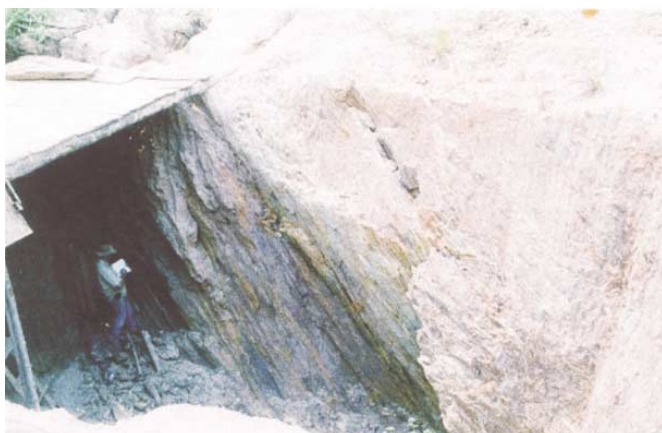
Fotografia 4.6 – Shaft do Gil, apresentando os planos da foliação milonítica com mergulhos altos para NE e estruturas lineares com caimento para E, marcando o eixo de dobras isoclinais e reclinadas.
