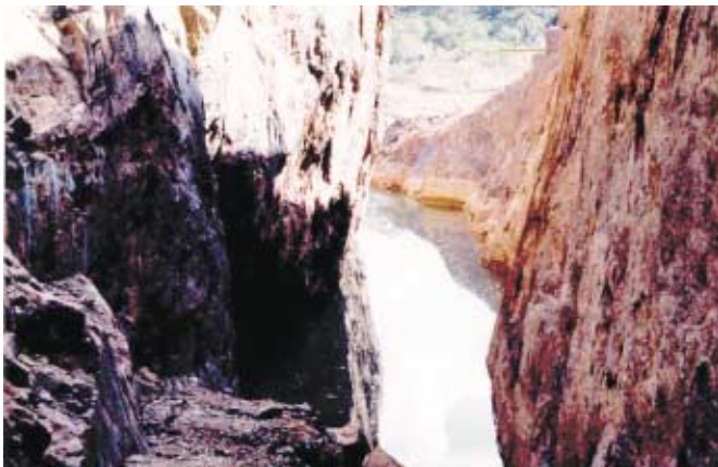
Fotografia 4.7 – Aspectos da trincheira da lavra do Garimpo do Tapajós, aberta ao longo do trend da foliação paralela ao filão aurífero.
