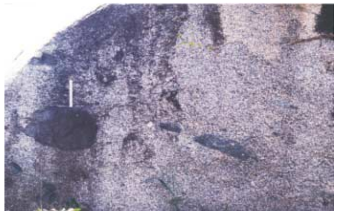
Fotografia 2.39 – Enclaves dioríticos de dimensões centimétricas, na forma de estruturas oblatas e amendoadas.
