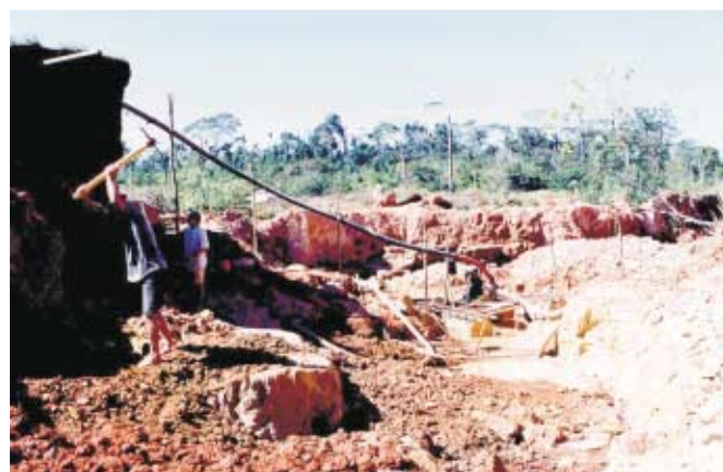
Fotografia 4.1 – Aspecto da lavra em latossolos e litossolos com desmonte manual e hidráulico desenvolvido sobre os saprólitos da Suíte Nova Canaã.
