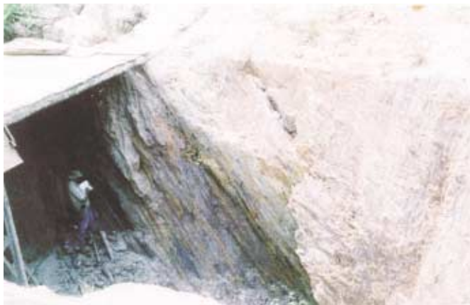
Fotografia 4.4 – Entrada do shaft do Gil, apresentando os planos da foliação milonítica com mergulho altos para NE e estruturas lineares com caimento para E, marcando o eixo de dobras isoclinais reclinadas (Santos, 2001).
