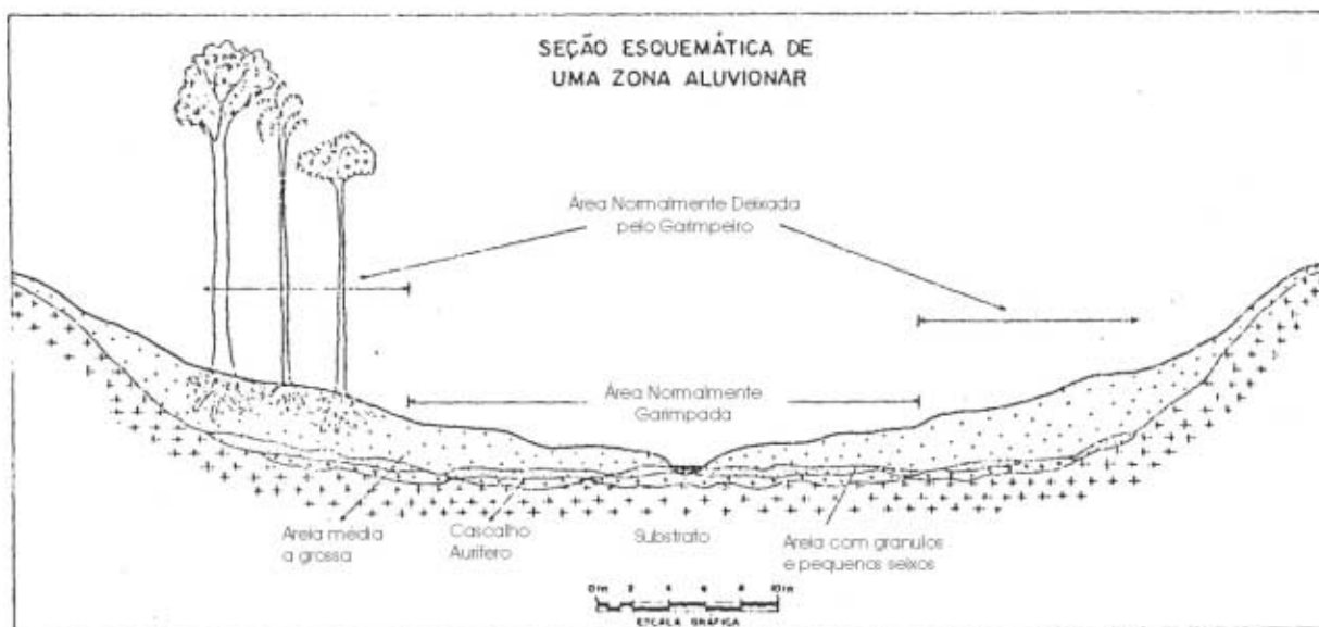
Figura 4.2 – Perfil esquemático da zona aluvionar na região, com as áreas de interesse utilizadas pelo garimpo, adaptado de Nogueira & Oliveira (1983).
