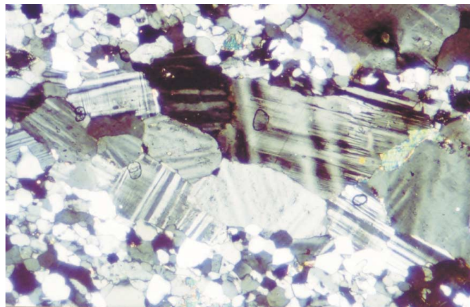
Fotomicrografia 2.19 – Mesma rocha da foto anterior, mostrando avançado processo de recrystalização com cristais de feldspato potássico poligonizados, LP x 2,5.
