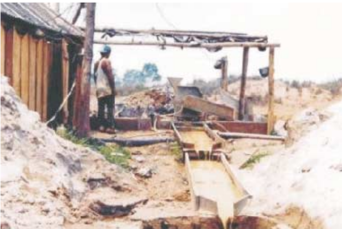
Fotografia 4.21 – Garimpo do Cabeça, região do Novo Astro. Sistema de beneficiamento do minério com moinho de martelo e caixas concentradoras com placa amalgamada no fundo. Observa-se que a água transporta muito material em suspensão e facilita as perdas, principalmente de ouro fino.
