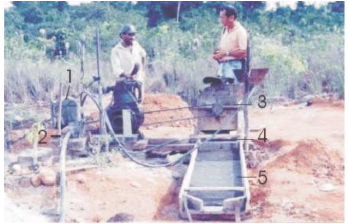
Fotografia 4.10 – Garimpo do Cunhadinho, região garimpeira do Novo Planeta. Equipamento rudimentar utilizado no beneficiamento do minério: 1) motor diesel estacionário; 2) bomba d'água; 3) moinho de martelo; 4) caixa com mercúrio; 5) caixa com placa de cobre amalgamada.
