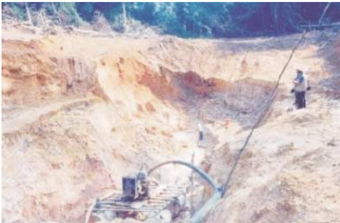
Fotografia 4.17 – Garimpo do Tião Fera, região do Novo Satélite. Desmonte hidráulico do saprólito com multivenulações de quartzo tipo “stockwork”.
