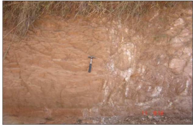
Figura 95 - Contato por falha vertical entre as rochas do embasamento e paraconglomerados da Formação Corumbiara (km 16 da RO 485, sentido Colorado-Corumbiara).
