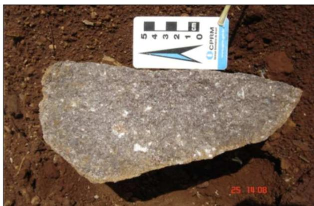
Figura 110 - Basalto da Formação Anari com amígdalas preenchidas por carbonatos.
