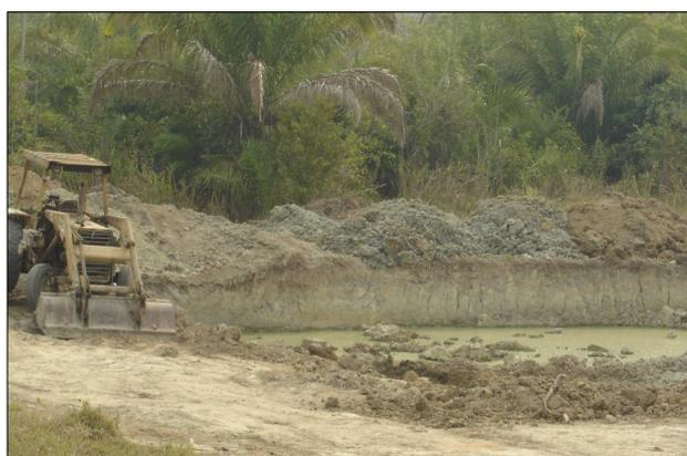
Figura 154 - Frente de lavra de argila plástica acinzentada na planície de inundação da margem direita do rio Jaru, cujo material é utilizado na fabricação de tijolos.
