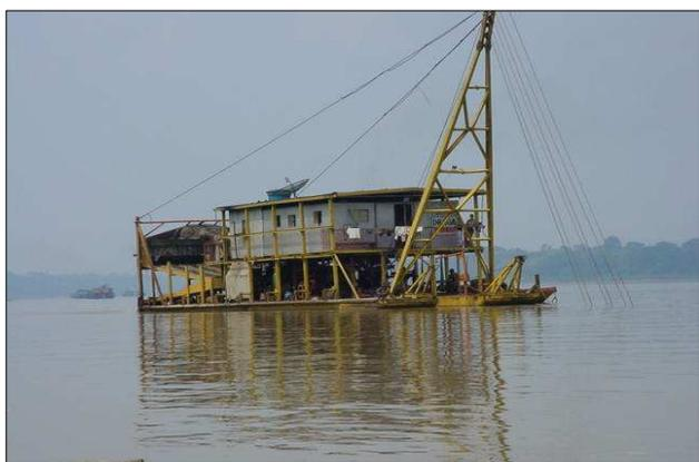
Figura 174 - Draga utilizada na extração de ouro dos aluviões do leito do Rio Madeira, no Município de Porto Velho, Rondônia.
