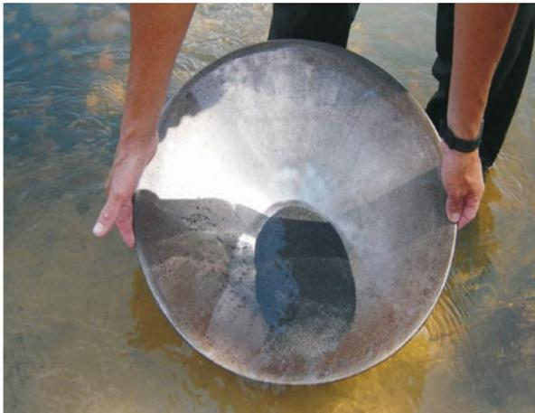
Foto 6.2 – Procedimento de coleta de concentrado de minerais pesados na Folha Juína.
