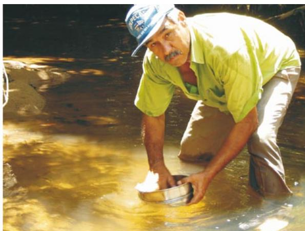
Foto 6.1 – Procedimento de coleta de sedimentos de corrente na Folha Juína.
