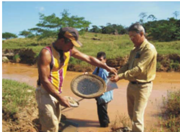
Foto 6.2 – Coleta de concentrado de peneira em sedimento aluvionar.
