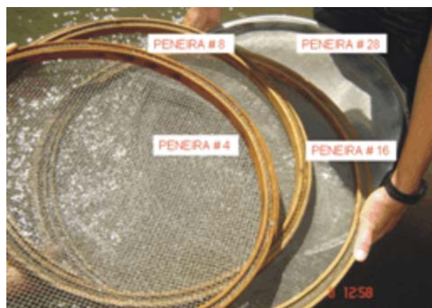
Foto 6.3 - Sequência de peneiras utilizada na classificação das amostras de concentrado de minerais pesados.
