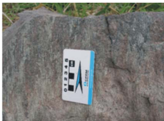
Foto 5.4 – Granito milonitizado com lineação de estiramento (MC-271).
