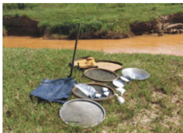
Foto 6.4 - Kit completo para amostragem de concentrados de minerais pesados (peneiras e bateia).
