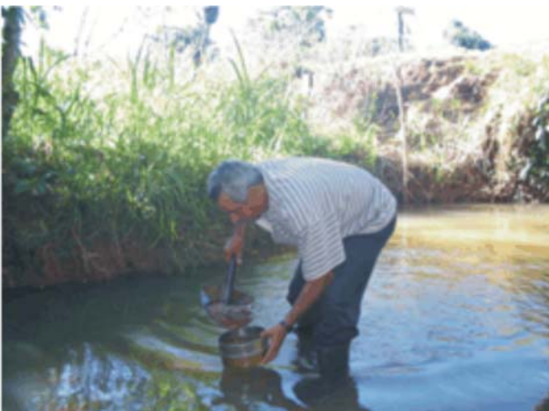
Foto 6.1 – Procedimentos de coleta de amostras de sedimentos de corrente.
