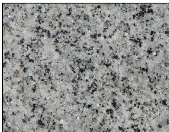
Figura 4.74: Detalhe da mineralogia e textura equigranular do Granito Mambucaba. Detalhe do afloramento anterior.
