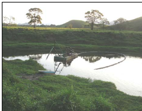
Figura 6.6: Extração de areia com draga em rio de planície. Angra dos Reis - RJ.
