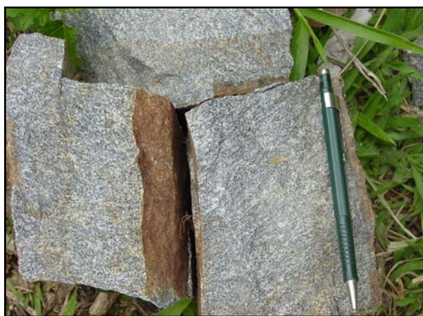
Figura 4.28: Detalhe do afloramento anterior, com a textura e composição dos ortognaisses do Complexo Campinho.
