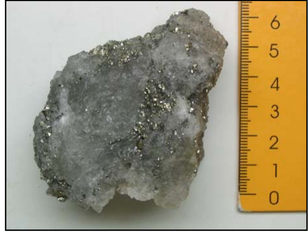
Figura 6.19: Amostra de pirita em rocha quartzosa porosa, mina inativa de Rio Claro - RJ.
