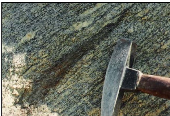
Figura 4.18: Hornblenda biotita gnaisse granítico, Complexo Quiríao sul de Valença, com enclaves de hornblenda gnaisse máfico.
