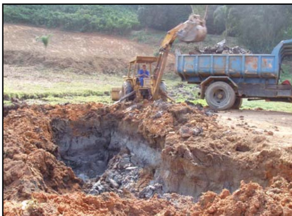
Figura 6.7: Extração de argila cinzenta em Piraí - RJ.
