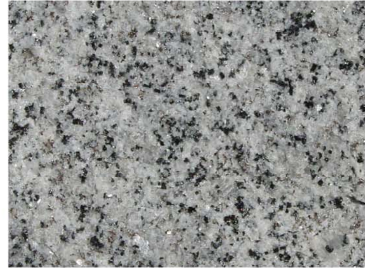
Figura 4.74-Detalhe da mineralogia e textura equigranular do Granito Mambucaba. Detalhe do afloramento anterior
