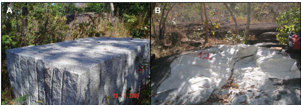
Figura 5.9: A. Extração experimental de blocos no extremo sudeste do granito Faina. B. Amostragem por detonação de leucogranito, próximo à fazenda Lagoa da Mata.
