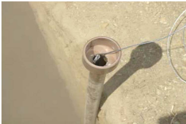
Foto 4.2.6 - Tubo de PVC de 1.1/4 utilizado para as medições de infiltração
