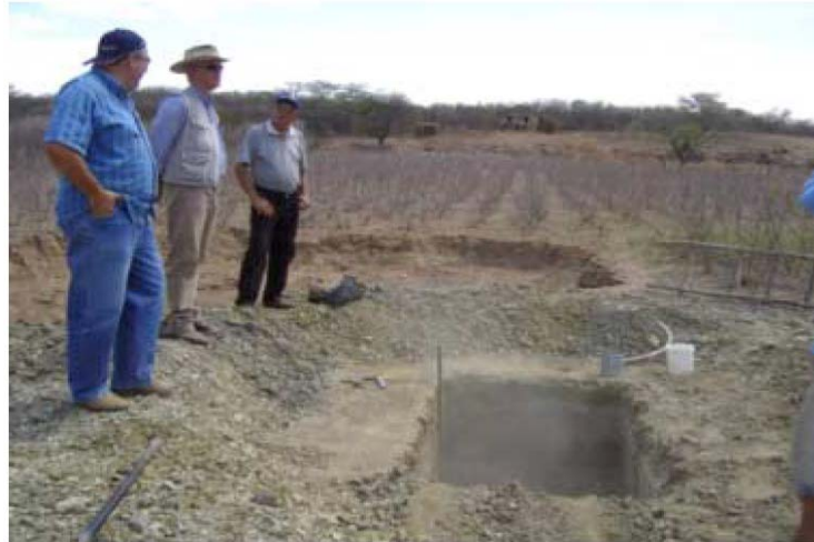
Foto 4.2.8 - Detalhe do lisímetro instalado em Serrote dos Estrela.
