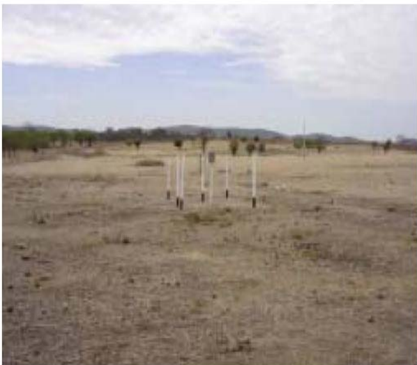
Foto 4.2.3 - Pluviômetro instalado na Faz. Santo Antonio em Santa Helena – PB.
