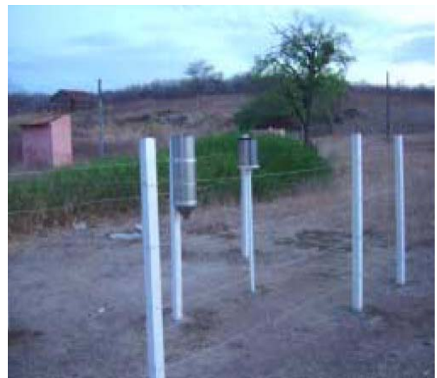
Foto 4.2.2 - Pluviômetro instalado na localidade de Serrote dos Estrela em Sousa-PB.
