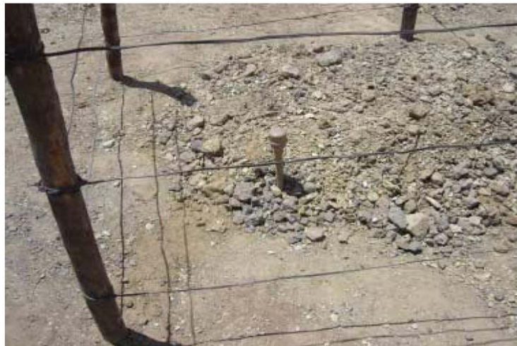
Foto 4.2.9 - Detalhe do lisímetro instalado em Serrote dos Estrela.
