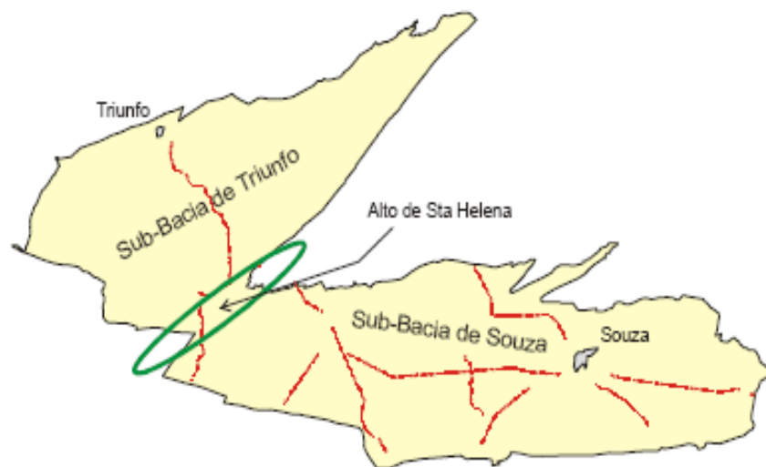
Figura 3.2..2 – Posição dos perfis (linhas vermelhas) de resistividade (Feitosa, 2006).
