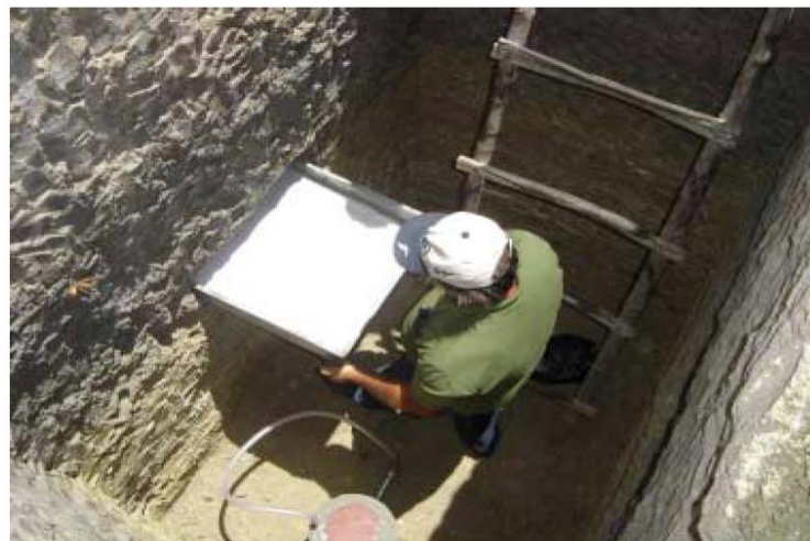
Foto 4.2.4 - Colocação da gaveta no lisímetro instalado na Fazenda Serrote dos Estrela.
