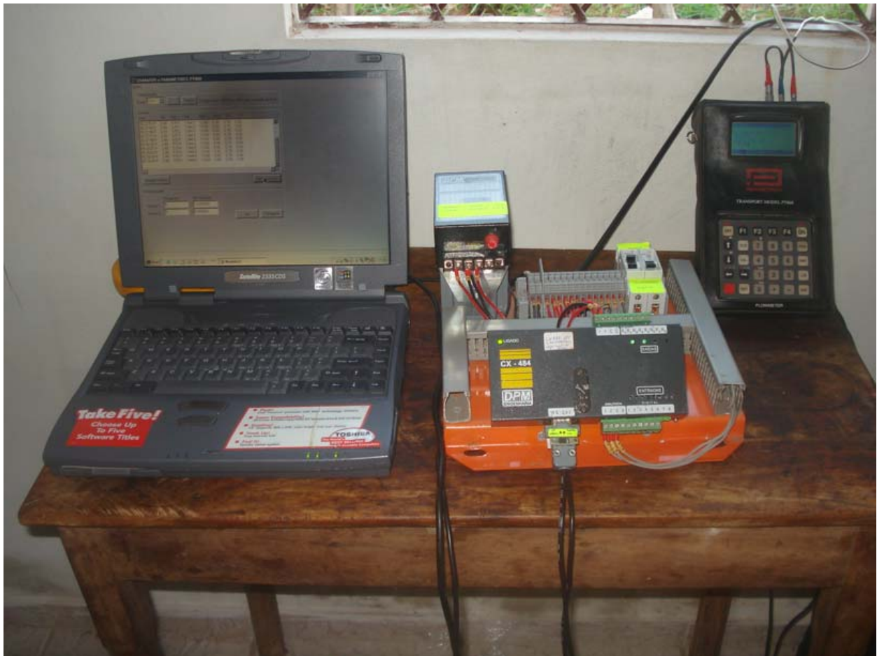
Detalhe do sistema de aquisição e armazenamento de dados para testes de aquífero
