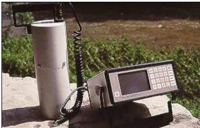
Figura 1 – Gamaespectrômetro Portátil EXPLORANIUM GR-320.
