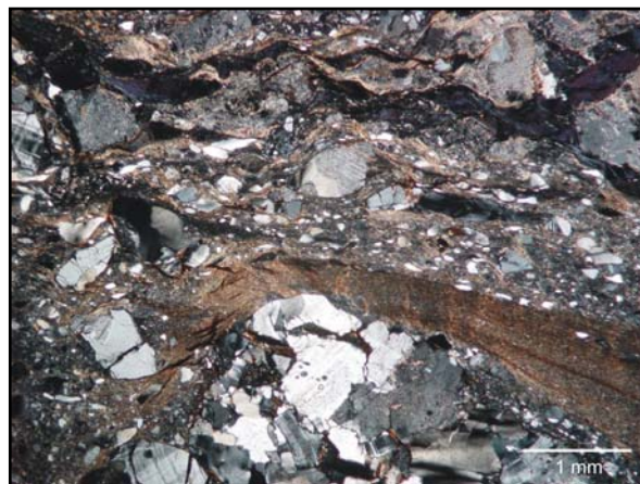
Figura 3.21: Clastos de granito, pelito e feldspatos em brecha/mélanges tectono-sedimentar da Formação Santo Hilário, Domínio Externo. Ponto SH-73-04 / Polarizadores Cruzados.
