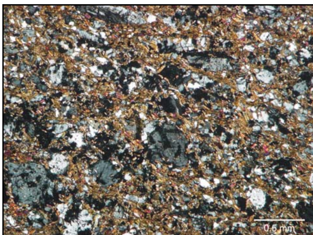
Figura 3.29: Fotomicrografia do epidoto biotita filito rico em albita interpretado como de origem vulcânica, que ocorre intercalado nas camadas basais da Nappe de Passos, na serra da Ventania. Polarizadores Cruzados.
