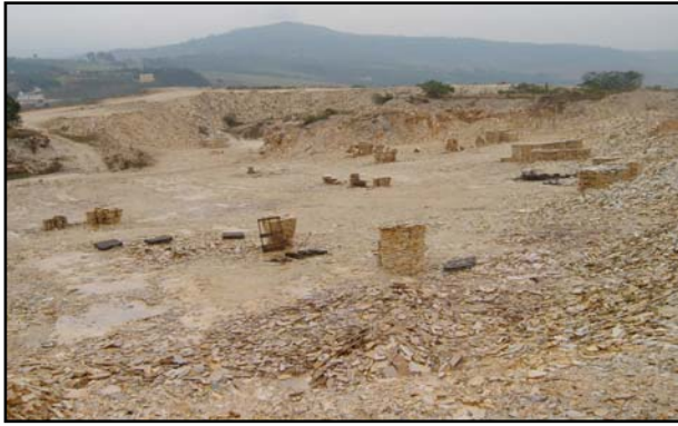
Figura 5.2: Placas de quartzitos prontas para serem transportadas para as serrarias.
