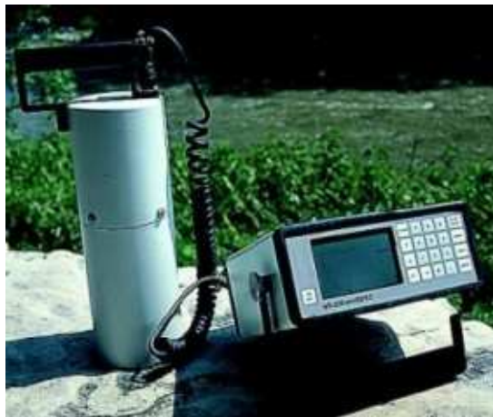
Figura 1 - Gamaespectrômetro Portátil GR-320
