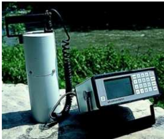
Figura 1 - Gamaespectrômetro Portátil GR-320
