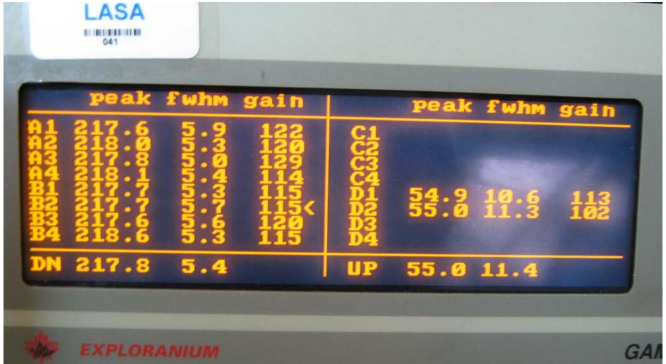
Foto tirada no dia 13/05/2010 no hangar em Jacarepaguá mostrando a resolução dos cristais do sistema Exploranium GR820 da aeronave PT-MEP
