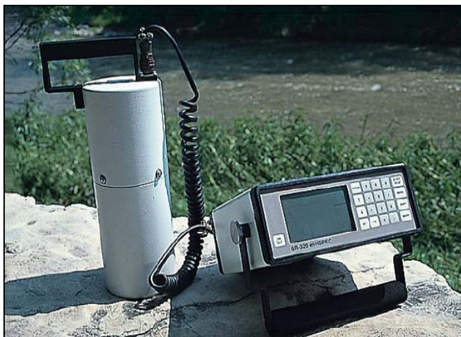
Figura 1 – Gamaespectrômetro Portátil EXPLORANIUM GR-320.
