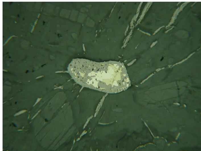
Foto 9.15 - Grãos de espinélio disseminados, com núcleos castanho escuro a marrom e bordas pretas, que indicam metamorfismo de médio grau (fácies anfibolito médio a baixo, núcleo marrom) e de baixo grau (borda preta), em metaperidotito da seqüência acamadada Ribeirão dos Motas, em amostra coletada no ponto MA 48 (luz refletida, polarizadores descruzados, negativo 0223.JPG).
