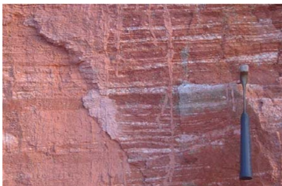
Foto 4.12 - Detalhe do Gnaiss Cláudio, observado no ponto IG 144, alterado para solo vermelho claro. Observar a preservação do bandamento mineralógico onde é possível distinguir as mais bandas félsicas de natureza quartzo-feldspáticas.
