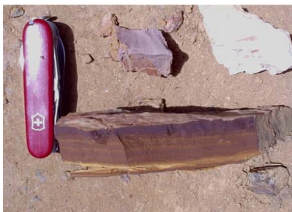
Foto 4.53 – Meta-argilito laminado, de coloração marrom avermelhada, impregnado por hidróxidos de ferro, observado no ponto HE 80.
