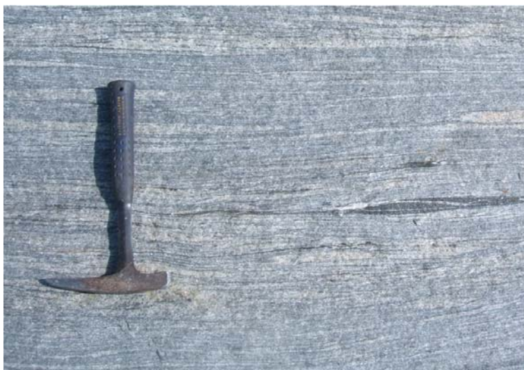
Foto 4.19 – Aspecto geral do Gnaiss São Tiago de cor cinzenta clara, observado no Ponto SC 62, exibindo o seu bandamento característico, composto por finas bandas máficas intercaladas com bandas leucocráticas (quartzo feldspática) mais grosseiras.
