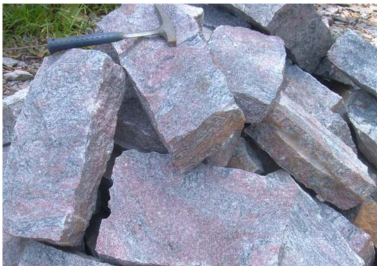
Foto 9.10 - Blocos de Gnaiss Itapecerica (folha Oliveira), preparados para material de construção civil e/ou pavimentação (ruas, jardins, etc), extraídos do ponto IG 63.
