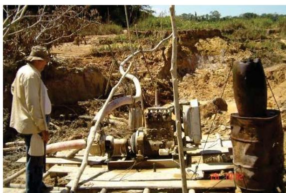
Foto 172 - Bomba de sucção que alimenta a planta rudimentar de concentração de ouro.
