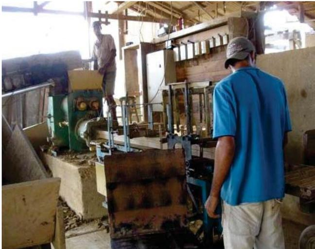
Foto 217 - Máquina para a moldagem dos tijolos.
