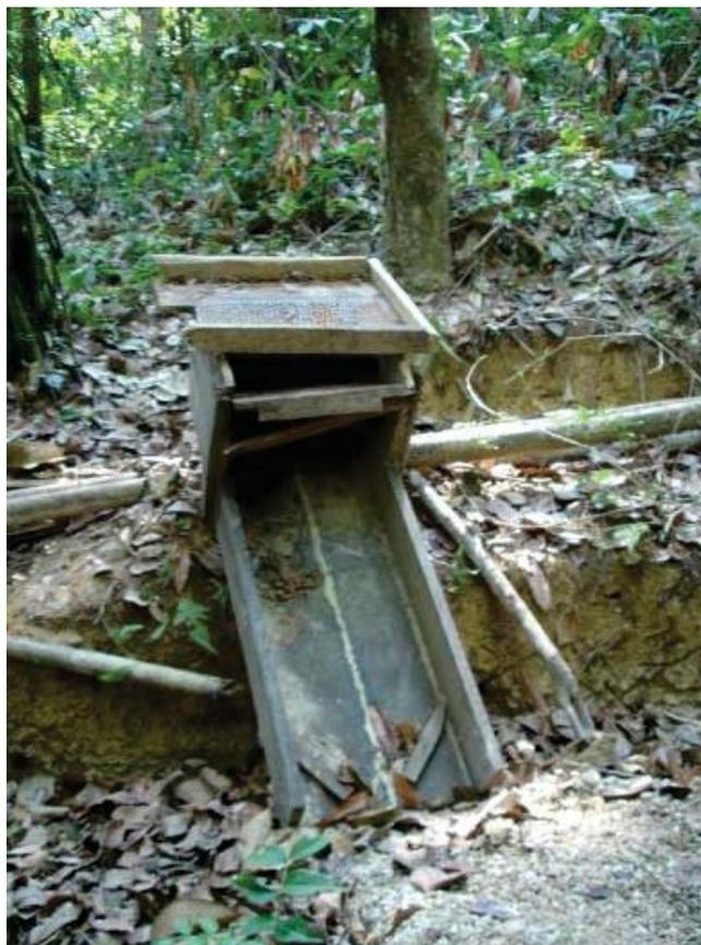
Foto 195 – Equipamento utilizado para concentração do ouro.
