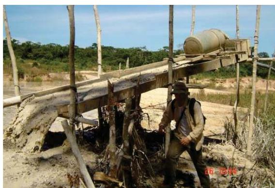
Foto 173 - Planta rudimentar ("Cobra Fumando") para concentração do ouro. Destaque para a alta densidade e velocidade de fluxo da lama que sai da caixa de concentração, responsável pelo baixo índice de recuperação do ouro, principalmente ouro fino e placóide.
