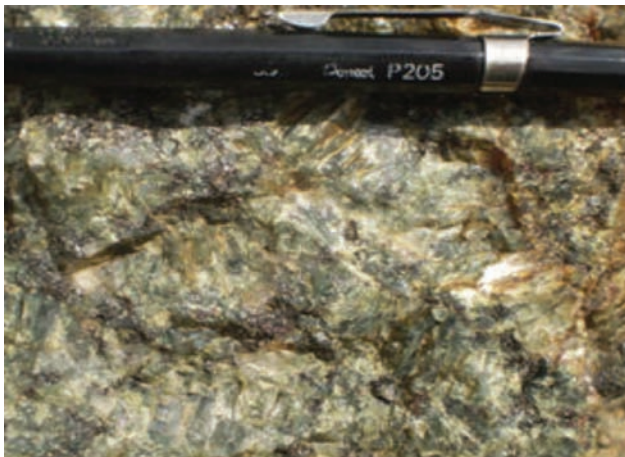
Figura 5.43 - Charnockito de granulação grossa com feldspato potássico verde da Suíte Aimorés (MF29)
