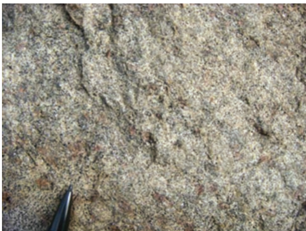
Figura 5.13 - Porção fundida de granada-biotita granito de granulação fina a média da Suíte Ataléia no paragneisse Nova Venécia (estação FM68)
