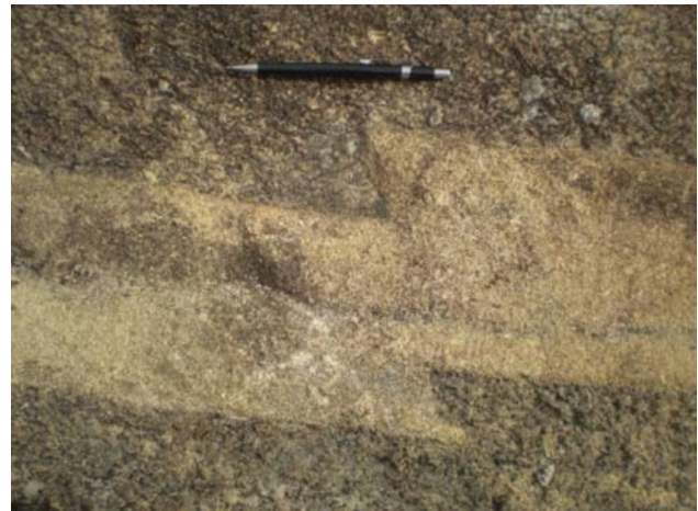
Figura 5.37 - Falhas em granitos da Suíte Ataléia mostrando caráter rúptil (estação MF243)
