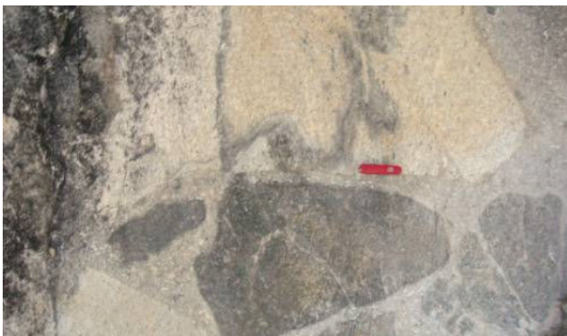
Figura 5.36 - Textura brechada mostrando caráter rúptil (estação MP16)
