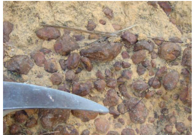
Figura 5.53 - Solo do Grupo Barreiras (camada superior) em contato com o nível de clastos de canga (camada inferior; estação FM7)
