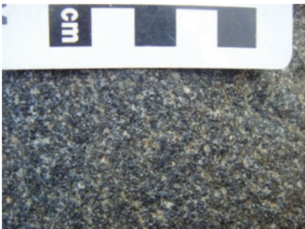
Figura 5.44 - Opdalito de granulação fina e coloração cinza escura da Suíte Aimorés (estação FM174)
