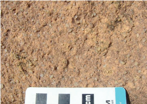
Figura 5.50 - Arenito conglomerático do Grupo Barreiras, onde se vê os grânulos de quartzo subangulosos a subarredondados numa matriz pelito-arenosa (seção S1)
