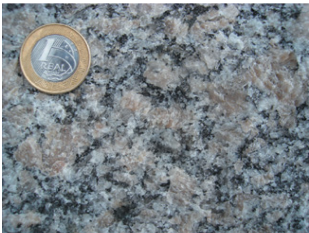
Figura 3.58 – Textura inequigranular porfírica no Granito Suruí. Pedreira Suruí, Suruí, situada na Rodovia Santos Dumont (BR-493, Rio-Teresópolis)
