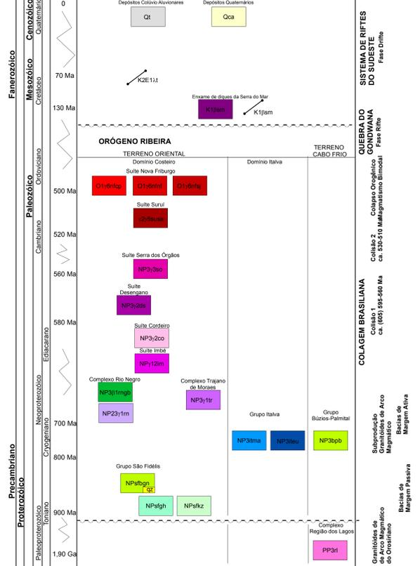
DEPÓSITOS COLÚVIO-ALUVIONÁRIOS: áreas com intercalações de argila, cascalho e restos de matéria orgânica. São sedimentos inconsolidados que ocorrem nos fundos de vales, em regiões planas, de granulometria variada, provavelmente de idade quaternária relacionados a depósitos fluviais.
