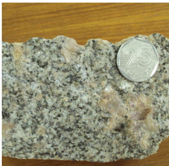
Figura 4.37 – Biotita-granito porfirítico, leucocrático, de cor branca a rosa-claro, do granito Patrimônio de Santo Antônio (NP3 \gamma 2lpa) (afloramento SW-594, Canastrão, Doutor Ulysses, PR).
