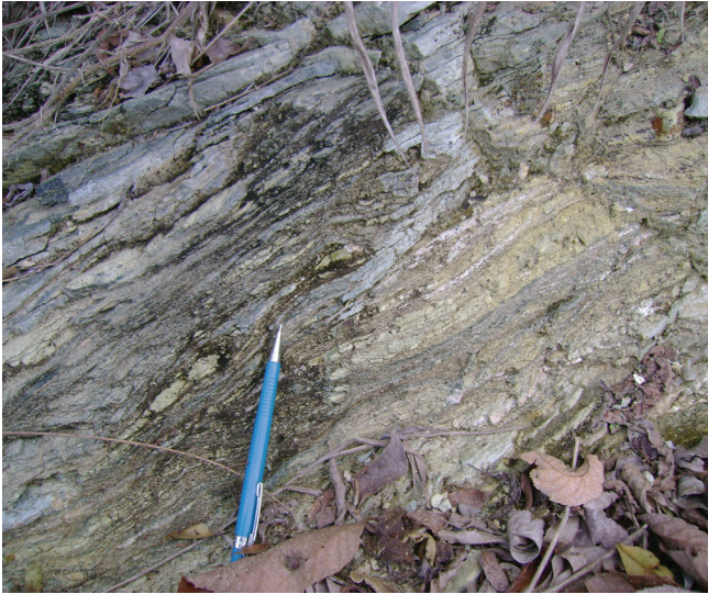
Figura 4.7 – Quartzo-micaxisto da unidade de xistos (MP1acx) da formação Água Clara, com bandamento centimétrico composicional alternando níveis mais micáceos ou quartzosos (afloramento SW-157, bairro do Morro Agudo, Barra do Chapéu, SP).
