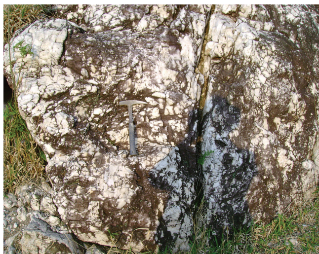
Figura 4.15 – Quartzito/metarenito de granulação fina a muito fina, cor branca, maciço e intensamente fraturado, da formação Serra dos Macacos (NP1iq) (afloramento SW-136, bairro das Almas, Bom Sucesso de Itararé, SP).
