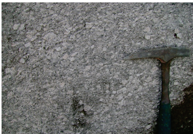
Figura 4.33 – Hornblenda-biotita-granito porfirítico, de cor cinza-claro, do granito Santa Rita (NP3 \gamma 2lsr) (afloramento SW-608, Caçador, Doutor Ulysses, PR).
