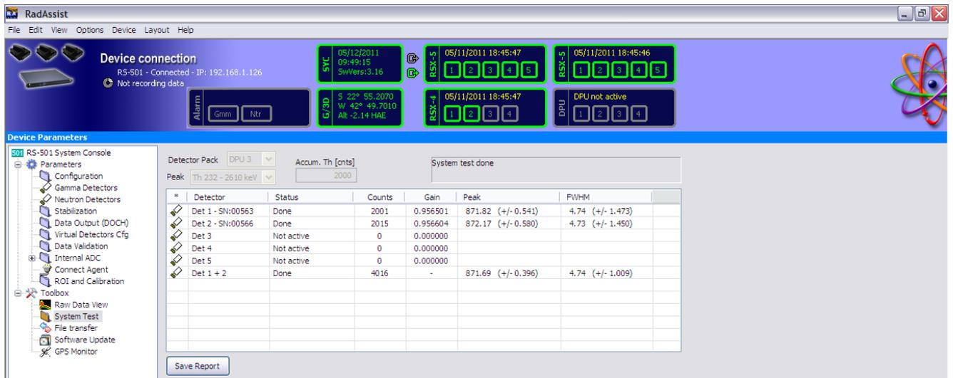
Arquivo (formato \*.jpg) gravado no dia 12/05/2011 no aeroporto municipal de Maricá-RJ mostrando a resolução dos cristais do sistema Radiation Solutions RS-500 da aeronave PR-PEC (Caixa C).
