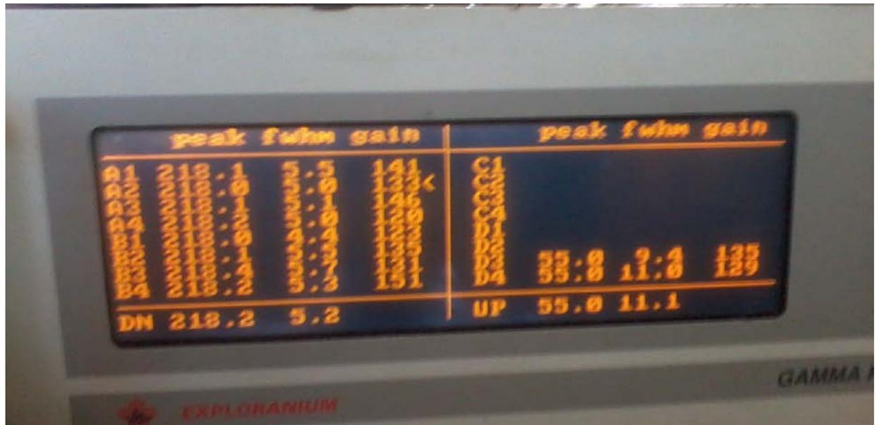
Foto tirada no dia 14/03/2012 no hangar em Jacarepaguá mostrando a resolução dos cristais do sistema Exploranium GR820 da aeronave PR-FAS
