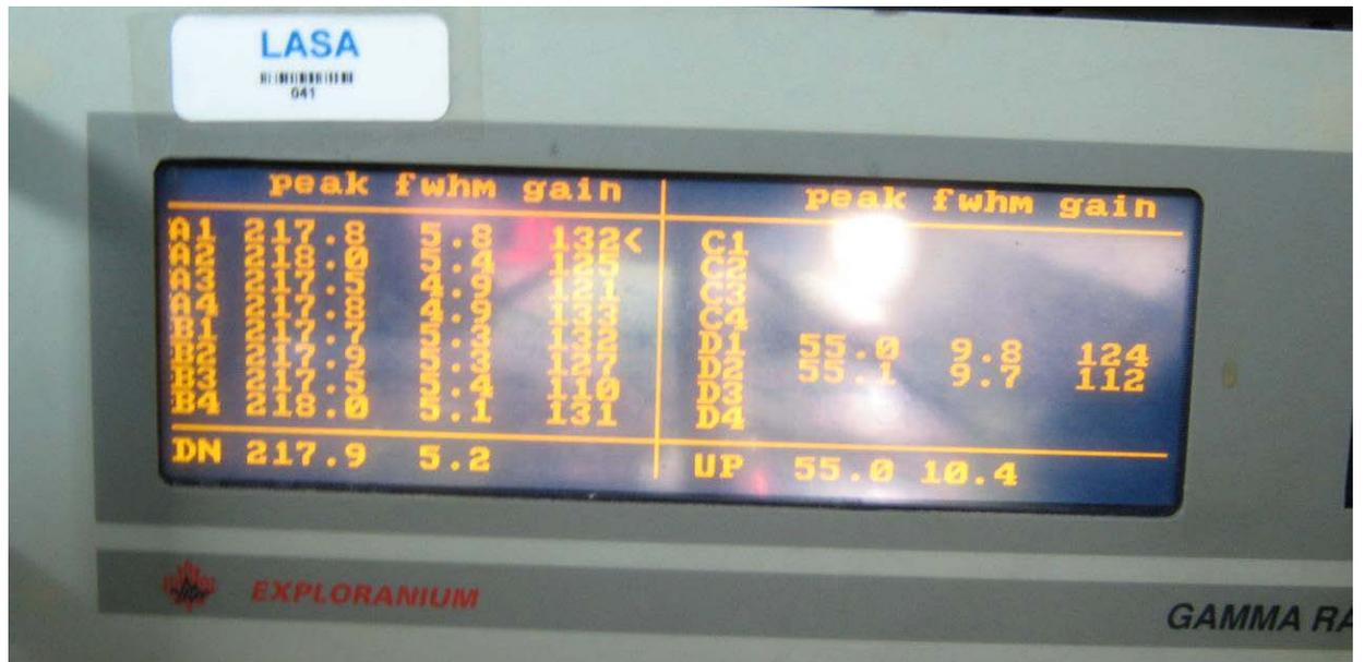
Foto tirada no dia 08/07/2011 no hangar em Jacarepaguá mostrando a resolução dos cristais do sistema Exploranium GR820 da aeronave PT-MEP
