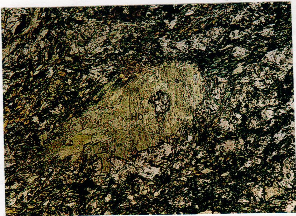
Fotomicrografia 7 - Porfiroblasto de hornblenda (Hb), sendo intensamente substituído por actinolita e clorita. A rocha é um plagioclásio-epidoto-anfibólio xisto, moderadamente deformado e recristalizado, com textura orientada (foliação tectônica) desviando-se ao redor do blasto de hornblenda. Ponto MJ-06. Aumento de 40 X. Nicóis paralelos.
