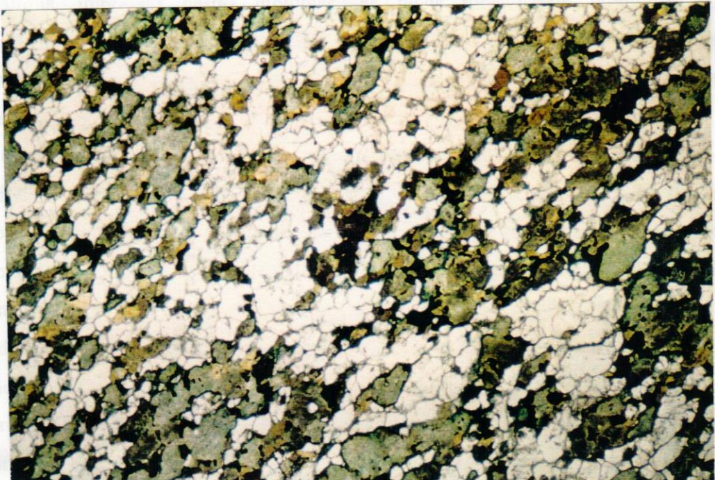
Fotomicrografia 37 - Textura granoblástica, orientada, resultante da deformação e recristalização de uma amostra da rocha metagabroica, onde os minerais constituintes encontram-se orientados segundo uma direção preferencial, definindo uma foliação. Ponto MJ-02. Aumento de 25 X. Nicóis cruzados.
