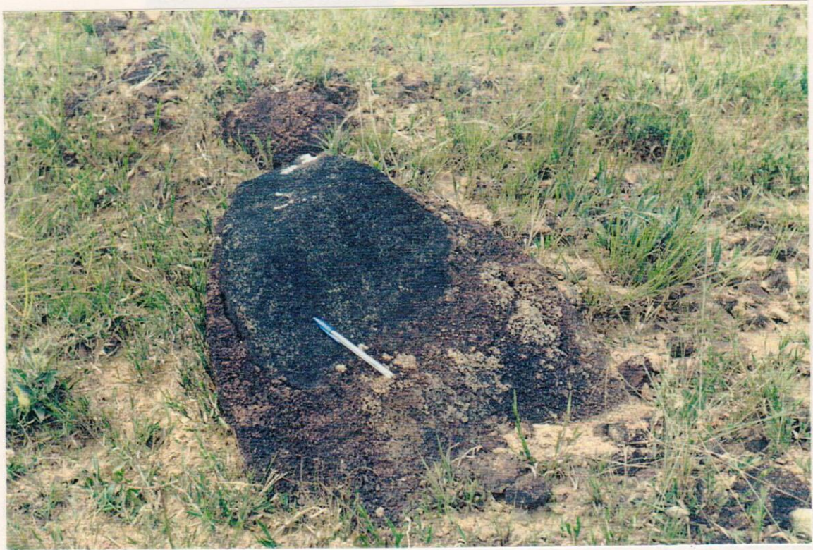
Fotografia 16 - Feição típica da alteração da rocha metagabroica, comumente observada nos blocos de seus litotipos, semelhante a uma esfoliação esferoidal, originando uma “casca” intempérica, áspera e rugosa, que nunca avança mais que 2 a 3 cm em direção ao interior dos mesmos. Ponto MJ-112.
