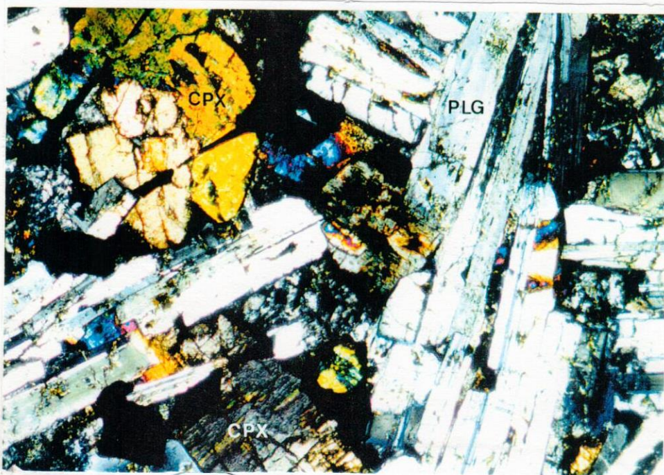
Fotomicrografia 42 - Textura de um dique básico não metamorfizado, exibindo uma trama do tipo glomerofítica seriada, caracterizada pela ocorrência de aglomerados de grãos de plagioclásio (Plg) e clinopiroxênio (Cpx), com granulometria variando de fina a média. Ponto MJ-03. Aumento de 40 X. Nicóis cruzados.
