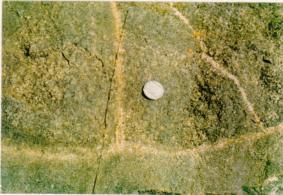
Fotografia 22 - Venulações estreitas, de espessuras milimétricas a centimétricas, aleatoriamente orientadas, cortando rochas metagabroicas. São feições bastante comuns nestas rochas, sendo resultantes do preenchimento de microfraturas, associadas a um evento deformacional rúptil, por epidoto e carbonato. Ponto MJ-01.
