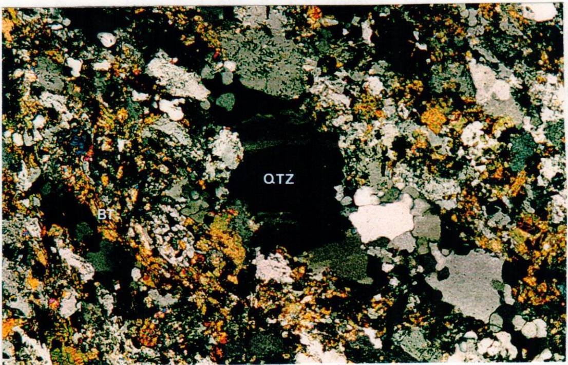
Fotomicrografia 11 - Rocha metatonalítica/metatrandjemítica intensamente deformada e recrystalizada. Notar o vigoroso e singular desenvolvimento de biotitas (Bt), ao longo de estreitas e descontínuas zonas de cisalhamento submilimétricas, e as pronunciadas bandas de deformação em grão de quartzo (Qtz) com extinção ondulante, delineando limites de subgrãos. Ponto MJ-43. Aumento de 40 X. Nicóis cruzados.
