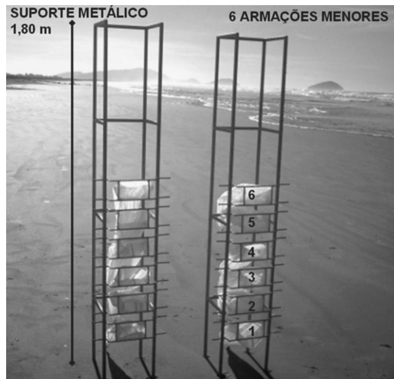
Figura 7: Estrutura utilizada na coleta de sedimentos, com suas dimensões e a numeração utilizada em cada uma das 6 redes.
