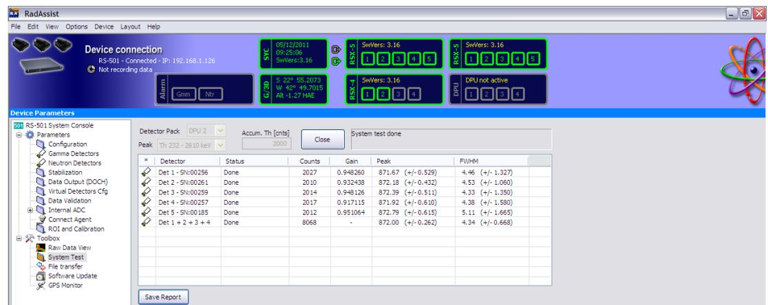
Arquivo (formato \*.jpg) gravado no dia 12/05/2011 no aeroporto municipal de Maricá-RJ mostrando a resolução dos cristais do sistema Radiation Solutions RS-500 da aeronave PR-PEC (Caixa B).
