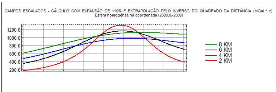
Figura 26: Perfil do campo potencial gravitacional calculado no domínio da transformada de Fourier com expansão de 100 % e extrapolação pelo inverso do quadrado da distância. Campo gerado por uma esfera homogênea situada nas coordenadas cartesianas (2000, 0,-2000).
