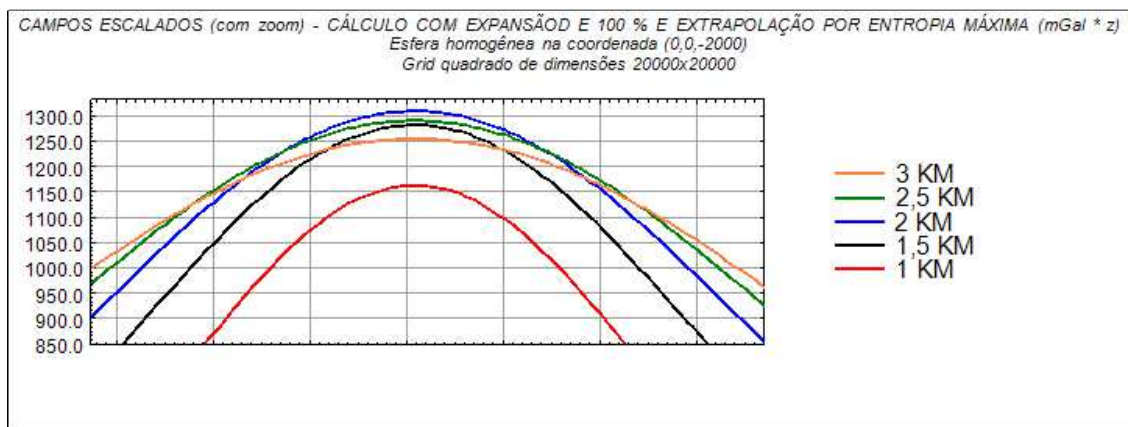
Figura 23: Perfil do campo potencial gravitacional (com zoom, para melhor visualização) calculado no domínio da transformada de Fourier com expansão de 100 % e algoritmo de extrapolação da entropia máxima de predição. Campo gerado por uma esfera homogênea situada nas coordenadas cartesianas (0, 0, -2000). A malha de dados possui dimensões quadradas de 20 km de comprimento por 20 km de largura. Os níveis de continuação para cima adotados foram de 1 km, 1.5 km, 2 km, 2.5 km e 3 km.
