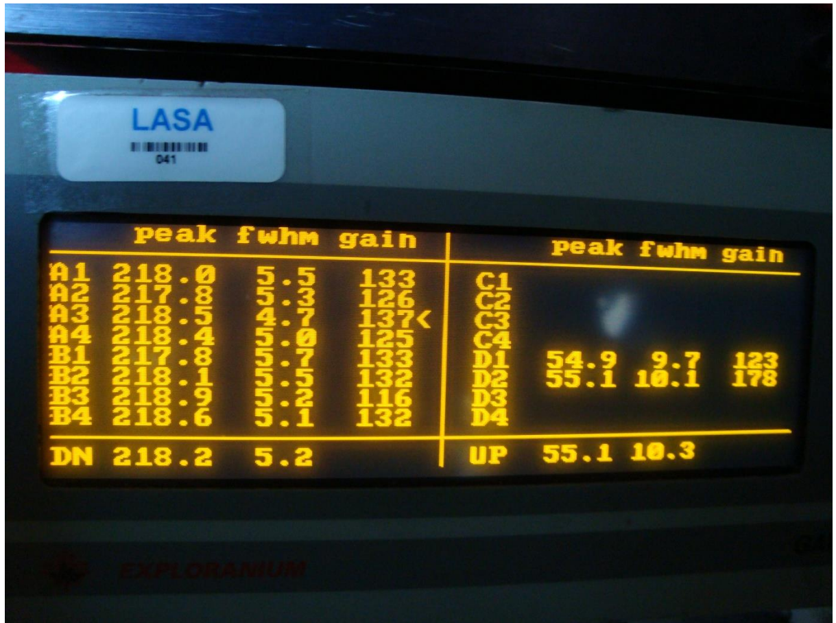
Foto tirada no dia 26/07/2012 no hangar em Jacarepaguá mostrando a resolução dos cristais do sistema Exploranium GR820 da aeronave PT-MEP
