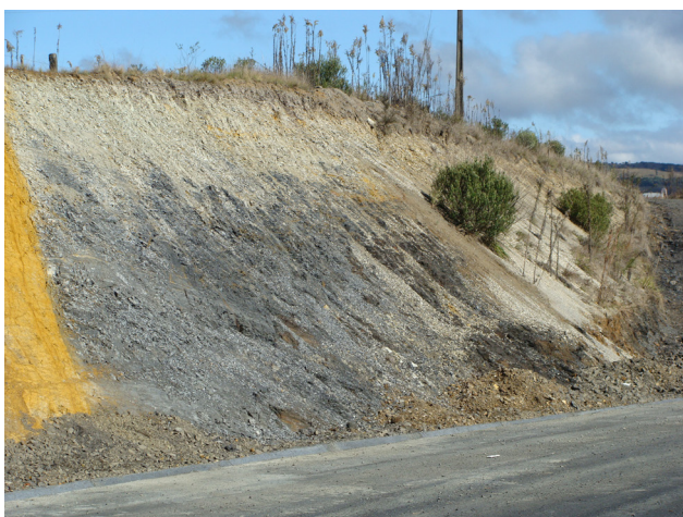
Figura 4.21 - Folhelhos cinza escuros alterados e com intensa fissilidade da Unidade Hidroestratigráfica Serra Alta, na BR-282 no município de Lages.
