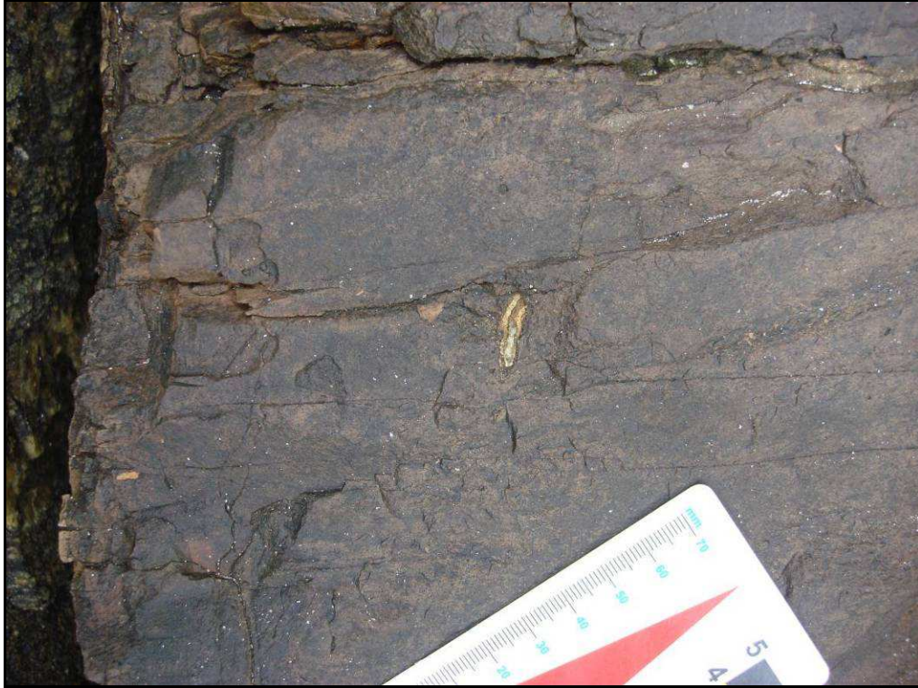
Figura 24 - Amígdala elipsoidal preenchida por material argiloso indicando a direção do fluxo, em dique de diabásio alcalino na Ponta da Baleia, região de Boiçucanga. Norte indicado na foto. Ponto MAR-JM-03.
