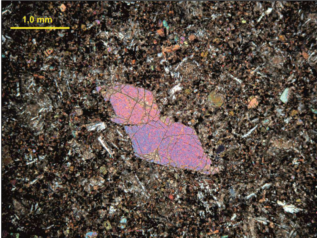
Figura 43 - Camptonito, da região de Juréia, de textura panidiomórfica, exibindo fenocristais de olivina, fraturados. Nicóis cruzados. Amostra: SAL-JM-02C.
