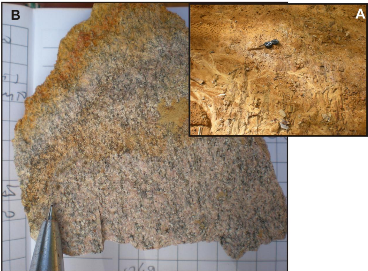
Figura 18: Quartzito (afloramento(a) e zoom em amostra de mão(b)). Observa-se que o quartzo e a biotita definem uma foliação fraca.
