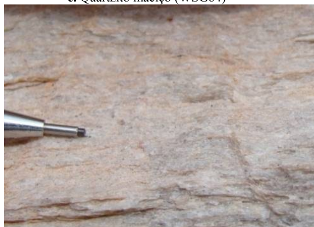
e. Quartzito fino a médio pouco micáceo (WSG72).
