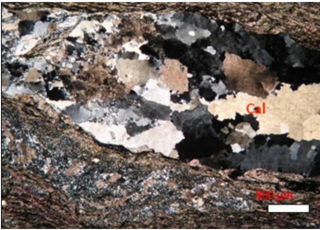
c. Fotomicrografia do veio de quartzo com calcita (RPF01b).
