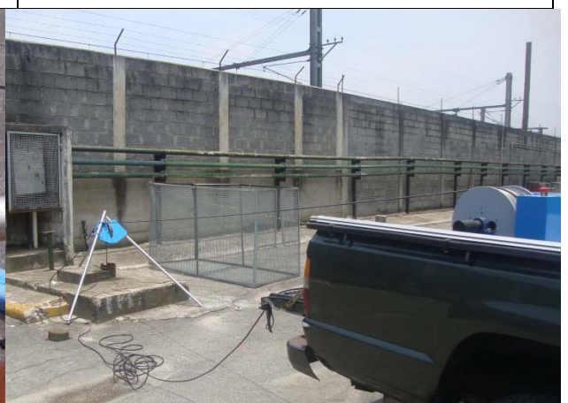
f) Posição do tripé sobre o poço e do guincho sobre carro de apoio
