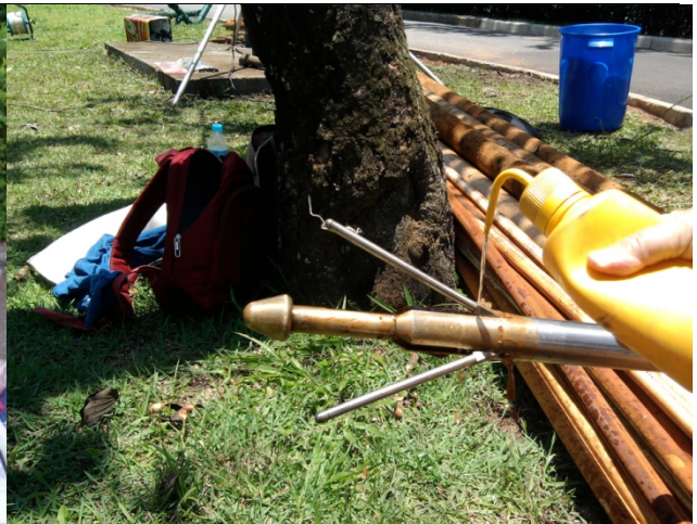
b) Hastes do perfilador de calibre, o qual é acoplado ao perfilador de radiação gama
