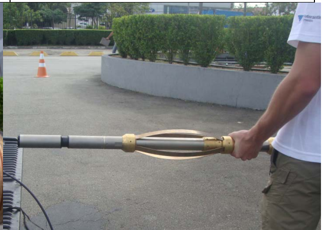
d) Extremidade da sonda de imageamento acústico com um dos centralizadores
