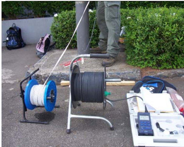
a) Medidor multiparâmetro e cabo utilizados nas perfilagens de condutividade elétrica e temperatura, junto ao medidor de nível d'água
