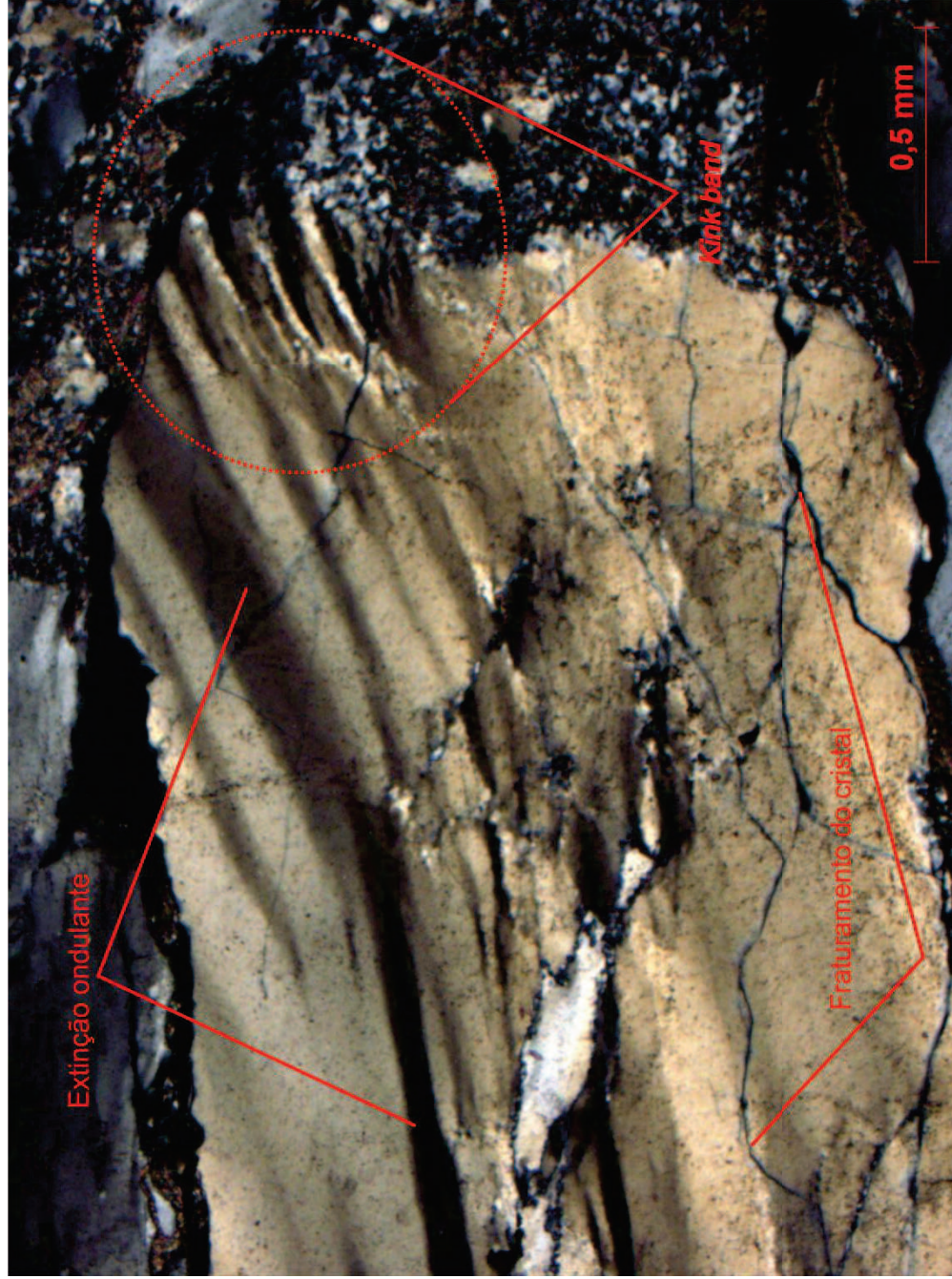
Fig 8.4 – Fm La Lola. Cristal de quartzo com deformação por kink band gerando extinção ondulante e fraturamento do cristal com abertura de espaço.
