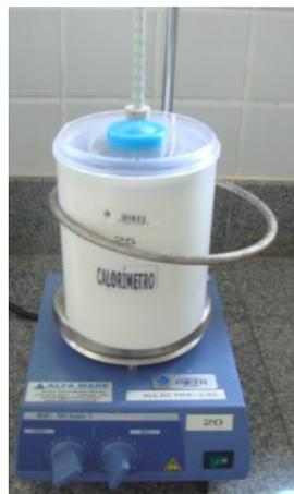
Figura 3.5 – Unidade Experimental utilizada para avaliar a reatividade da cal segundo a Norma ASTM-C-110-76.
