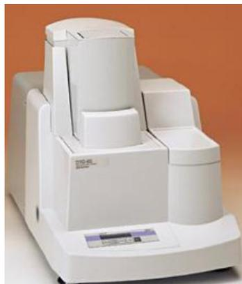
Figura 3.3 – Analisador Termogravimétrico Shimadzu DTG 60.
