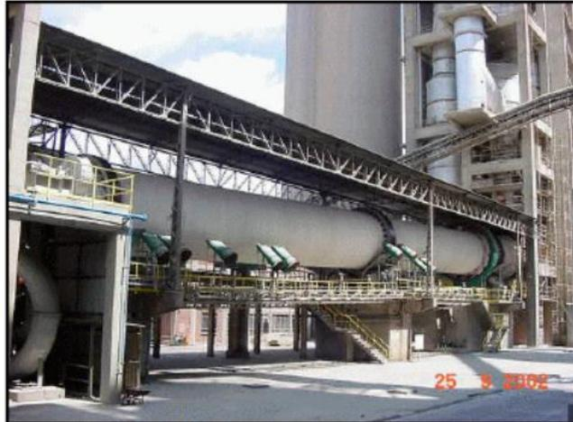
Figura 2.10 – Forno Rotativo utilizado para produzir cal pulverizada (TOMÁS, 2007).
