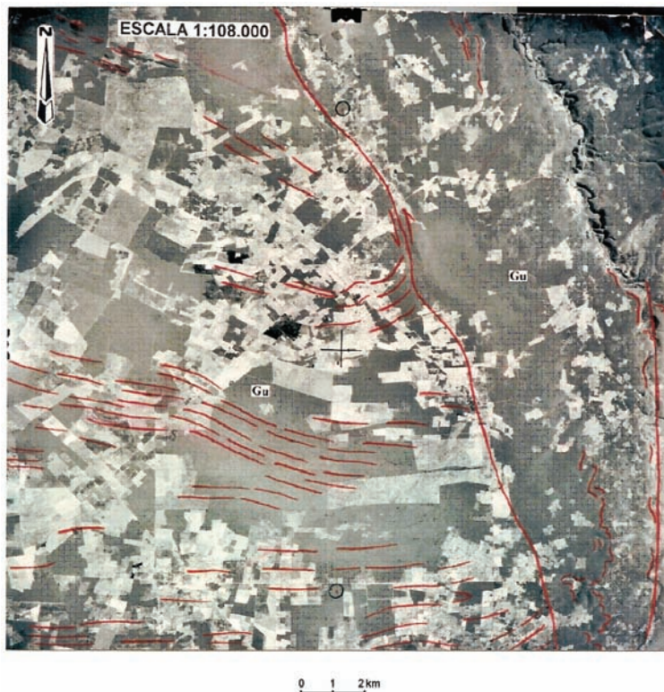
Foto 8 - Fotografia aérea da parte central do Estado da Bahia, a qual assinala a rampa lateral contida nos calcários do Grupo Una (Gu). A foto mostra grande descontinuidade na falha transcorrente sinistral, que limita o bloco leste com camadas horizontalizadas e relevo tabular, do bloco oeste, que possui rochas projetadas na direção E-W e com mergulhos de moderados a fortes.
