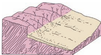
Figura 5.16 - Escarpa de falha caracterizada por formação de faces trapezoidais. O avanço da erosão proporciona faces triangulares que aparece na figura. Com o prosseguimento da erosão são formados cones de dejeção, indicando que a falha não é tão recente. Vergara (1971).
