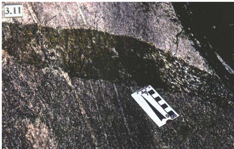
Figura 3.9 - Exemplo de regime dúctil-fragil tardi-D 3 no ortognaisse bandado. Observa-se zona de cisalhamento NW sinistral, com intrusão de material pegmatítico, confirmando a idade Brasileira para este evento. Afloramento AA01.
