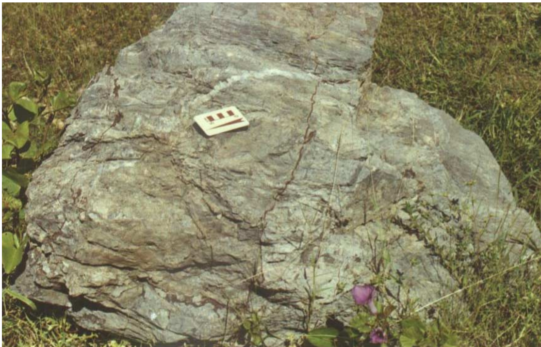
Figura 4.24b - Mesmo afloramento da Figura anterior. Ultracataclasito com finos veios de pseudotaquítilo preenchendo fraturas.
