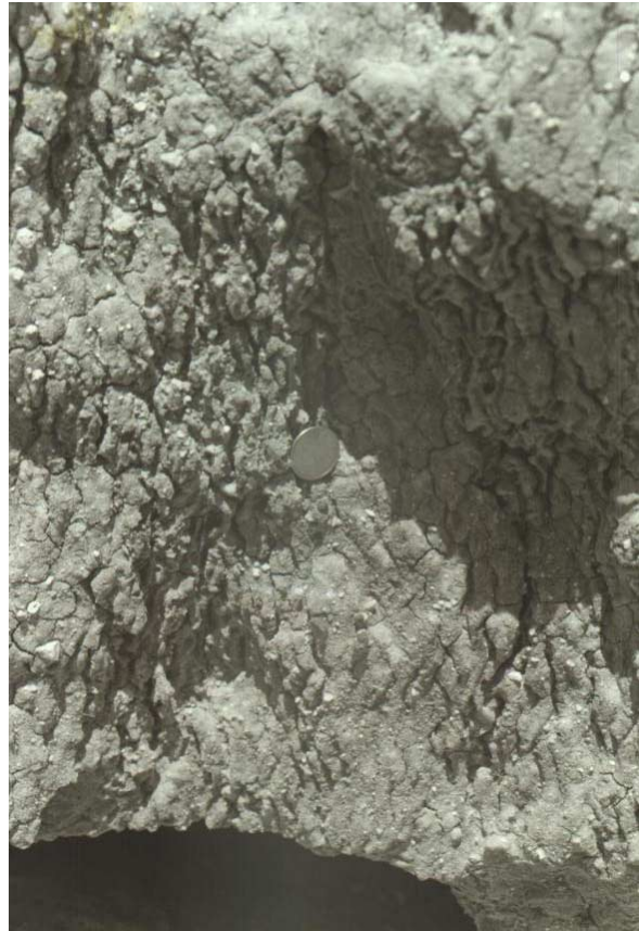
Figura 4.20 - Depósito de colúvio recente, apresentando fraturas conjugadas. Evidência de neotectonismo, com extensão N-S. Foto tirada em perfil com visada para W. Afloramento AA21.
