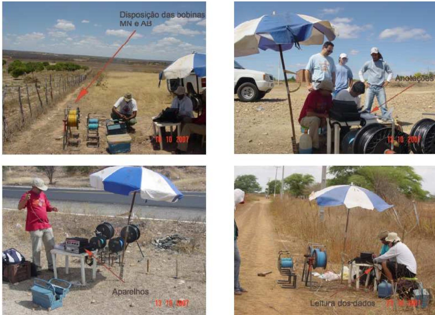
Figura 4.5: Detalhes da execução das SEV's ao longo da seção transversal ao Rifte Potiguar, próximas as margens da BR-304.
