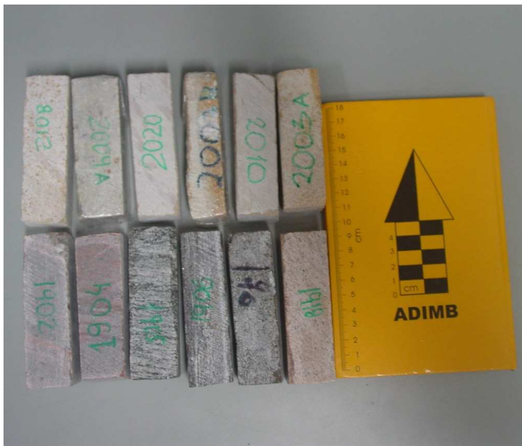
Figura 4.11: Amostras de rochas cortadas em blocos para o ensaio de densidade média das principais unidades geológicas da Bacia Potiguar estudadas neste trabalho.
