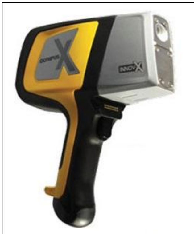
Figura 3.3 – Aparelho Delta Handheld XRF Analyzers utilizado para aquisição quantitativa química das amostras de rochas (Olympus, 2013).
