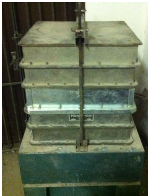
Figura 6 – Série de peneiras e agitador mecânico utilizado nesta pesquisa (LEMETRO-Departamento de Geologia da UFRJ)
