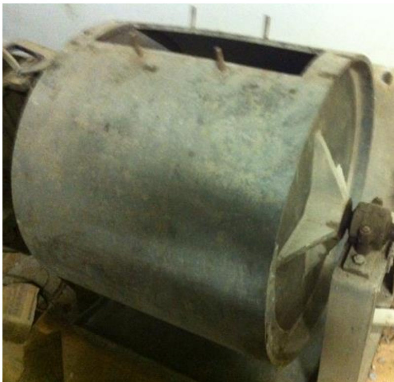
Figura 26 - Tambor do aparelho Los Angeles utilizado neste estudo (LEMETRO-Departamento de Geologia da UFRJ)
