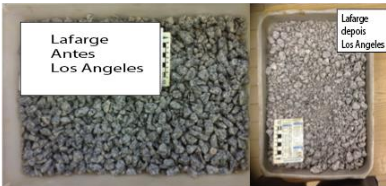
Figura 40 – Granito da pedreira Lafarge antes e depois do ensaio Los Angeles nesta pesquisa
