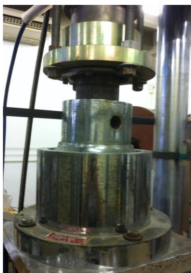
Figura 28 - Prensa e célula para o ensaio de esmagamento, utilizada nesta pesquisa (LEMETRO-Departamento de Geologia da UFRJ)
