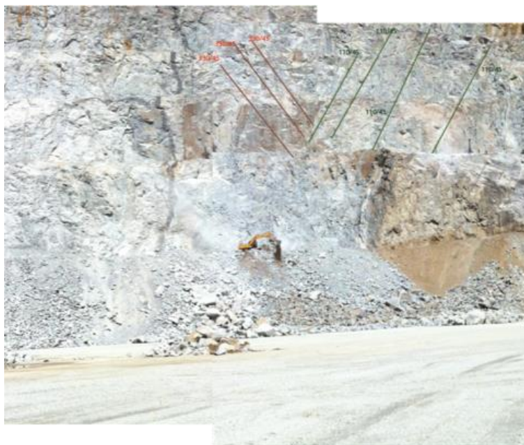
Figura 16 - Frente da pedreira Vigné durante a visita deste estudo com duas famílias de fraturas tectônicas marcadas
