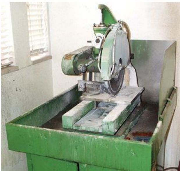
Figura 24 – Serra diamantada usada para cortar fragmentos de rochas na confecção de lâminas delgadas (figura retirada da internet)
