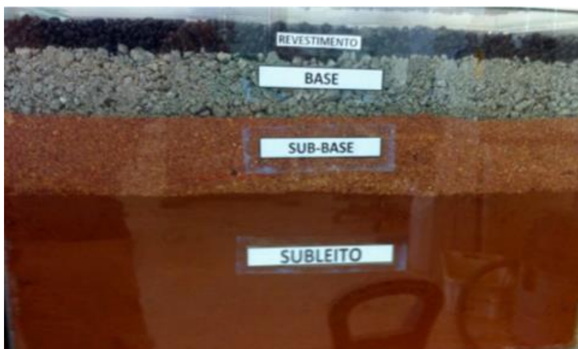
Figura 1 - Modelo físico de um pavimento asfáltico mostrando as camadas de uma pista de rodovia (Laboratório de Geotecnia da COPPE)
