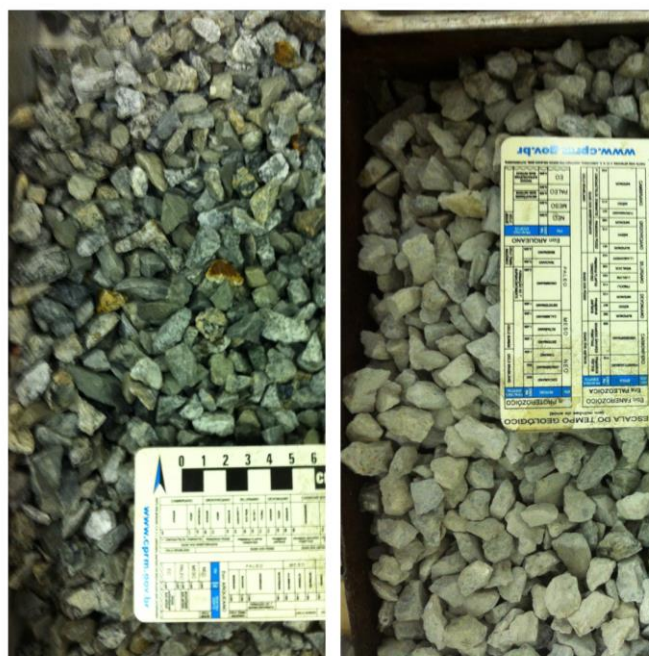
Figura 8 - Heterogeneidade dos agregados da pedra Vigné na amostra deste estudo: (a) depois de lavar e (b) antes do processo de lavagem e secagem
