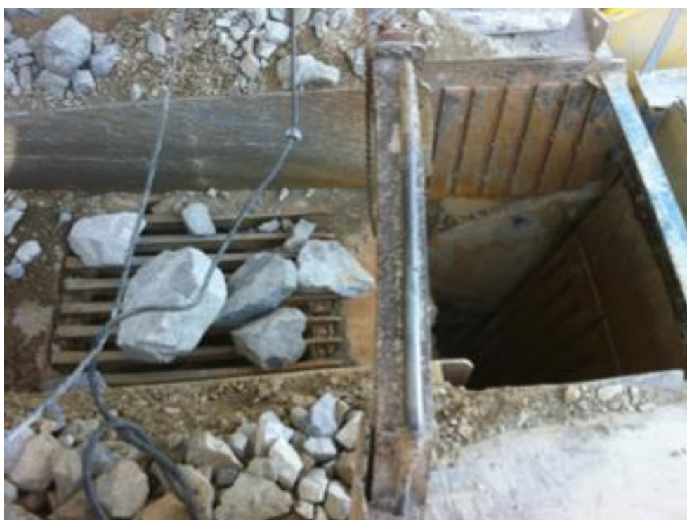
Figura 19- Britador primário de mandíbula da pedra Vigné durante a visita deste estudo
