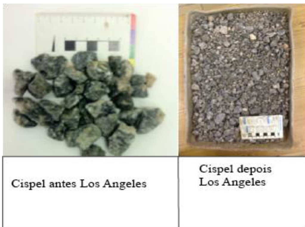
Figura 38 – Biotita - gnaiss da pedreira Cispel antes e depois do ensaio Los Angeles nesta pesquisa
