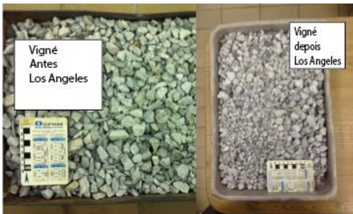
Figura 39 – Traquito e sienito da pedreira Vigné antes e depois do ensaio Los Angeles nesta pesquisa
