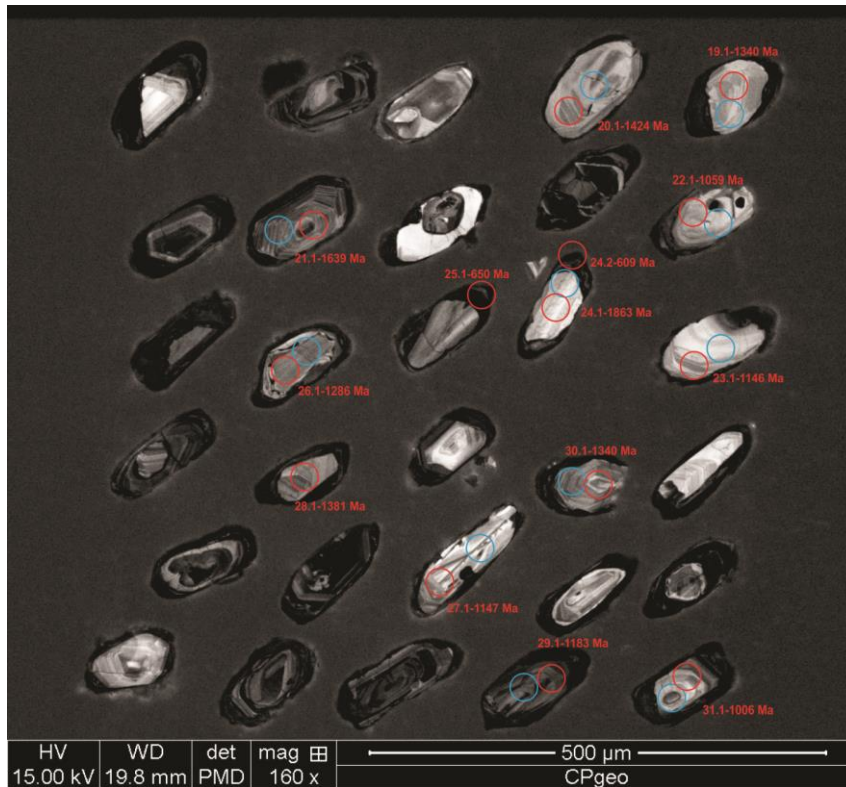
Figura 132: Imagem de catodo luminescência de raio X de zircões da amostra SNA 125. Em vermelho, análises U-Pb.
