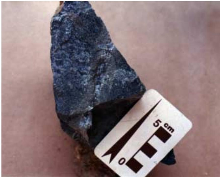
Figura 2.10: Microtonalito Caxias hidrotermalizado (EK-CX 65), cortado por vênula de quartzo. As paredes da vênula encontram-se descoloridas pelo efeito hidrotermal.
