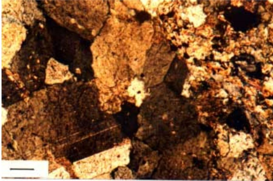
Figura 2.13: Fotomicrografia do microtonalito Caxias hidrotermalizado (EK-CX 65), mostrando a preservação local do plagioclásio. Nicóis cruzados. Comprimento da barra: 0,2 mm.
