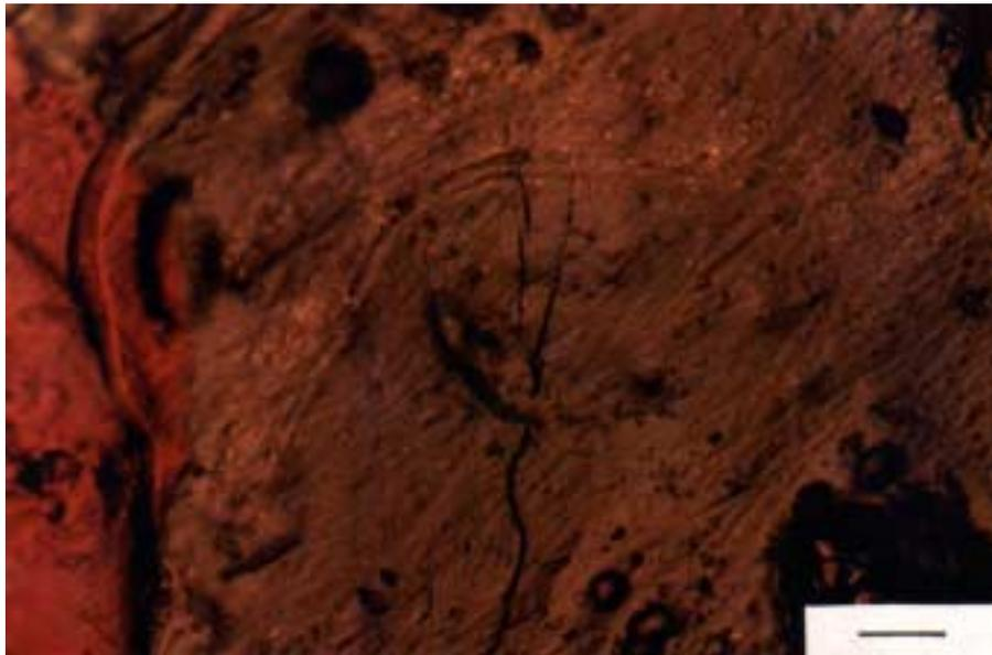
Figura 2.28: Fotomicrografia mostrando partícula de ouro (centro da foto, ao lado da fratura) em xisto do Caxias-S (EK-CX 64). Luz natural. Comprimento da barra: 0,2 mm.
