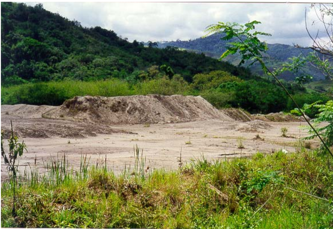
Foto 11: Pilha de rejeito proveniente do processo de beneficiamento do minério de chumbo, produzido pela refinaria Plumbum
