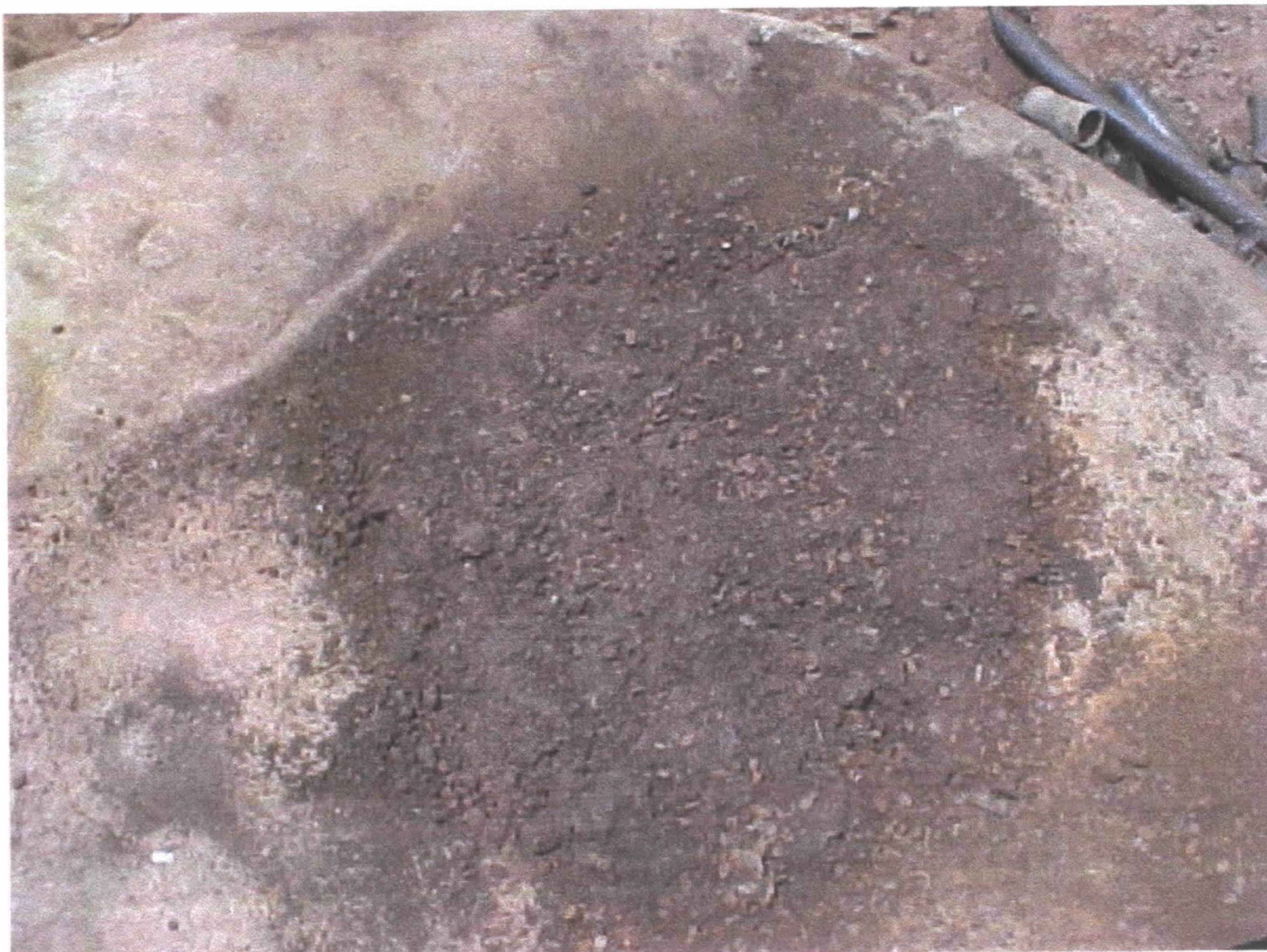
Foto 31 – Detalhes de materiais cortados e retirados com circulação direta
