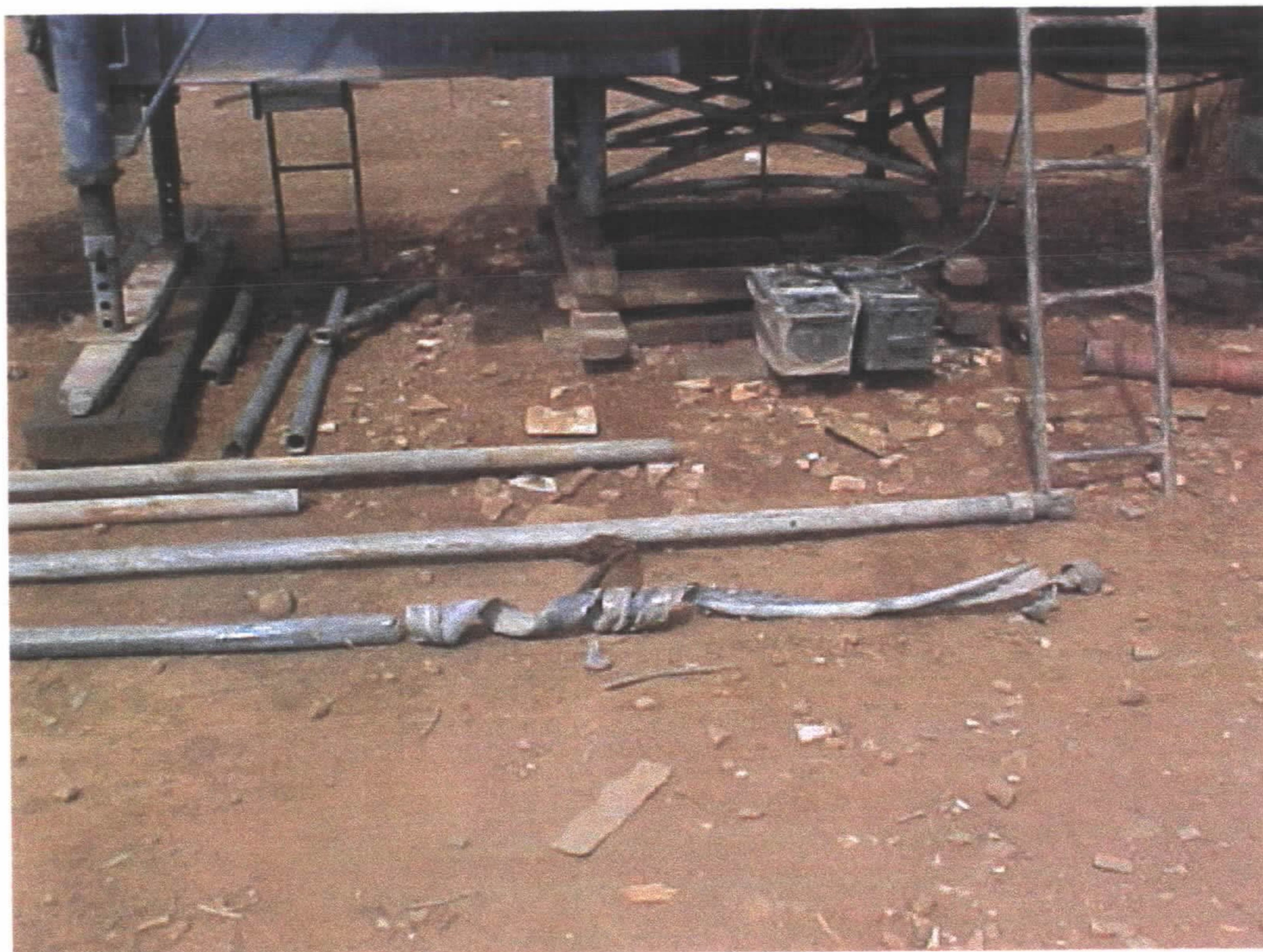
Foto 28 – Tubos intactos e retorcidos cortados/pescados pela sapata/comandos
