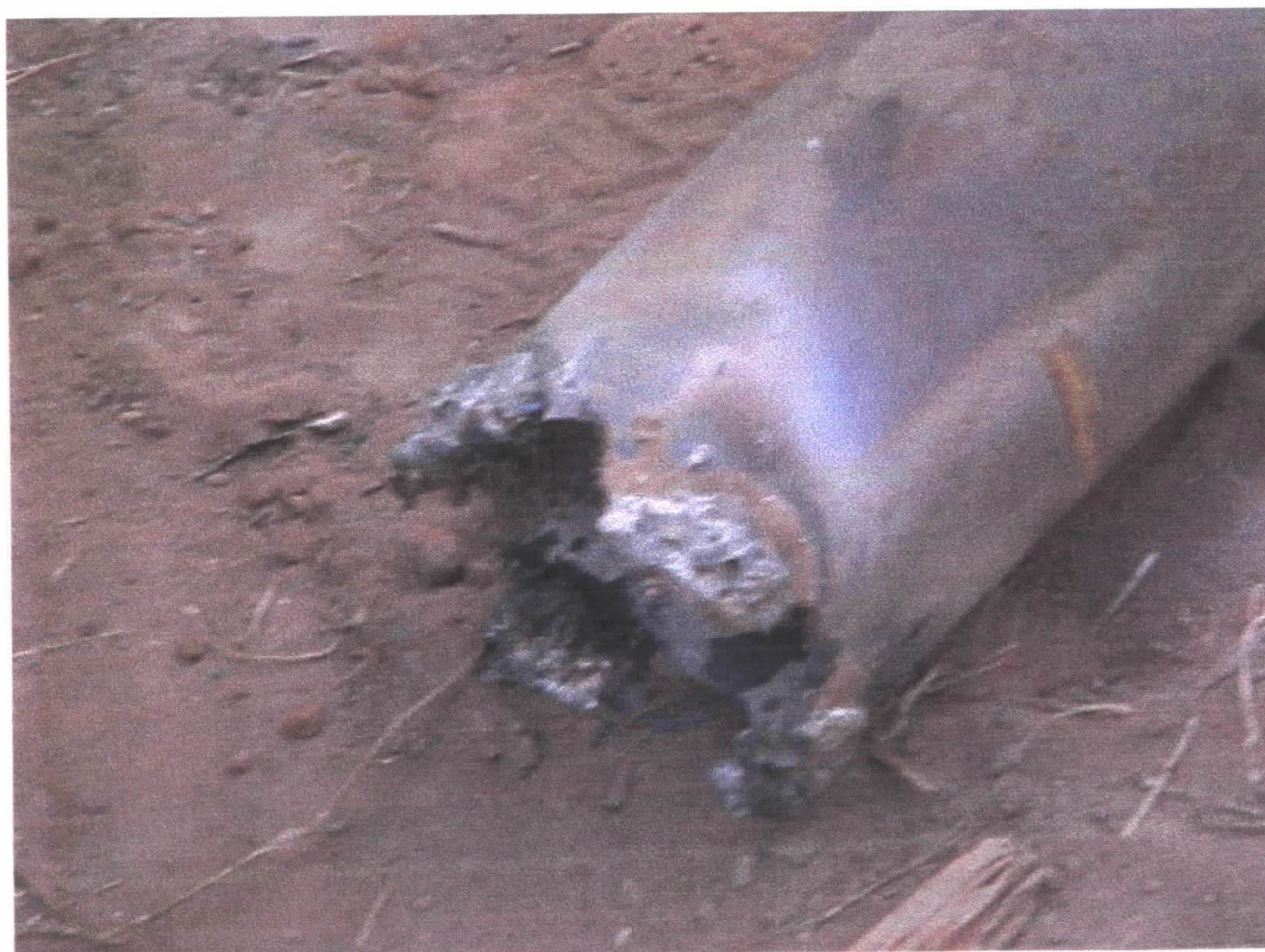
Foto 21 – Detalhe da sapata utilizada nos trabalhos de corte/pescaria
