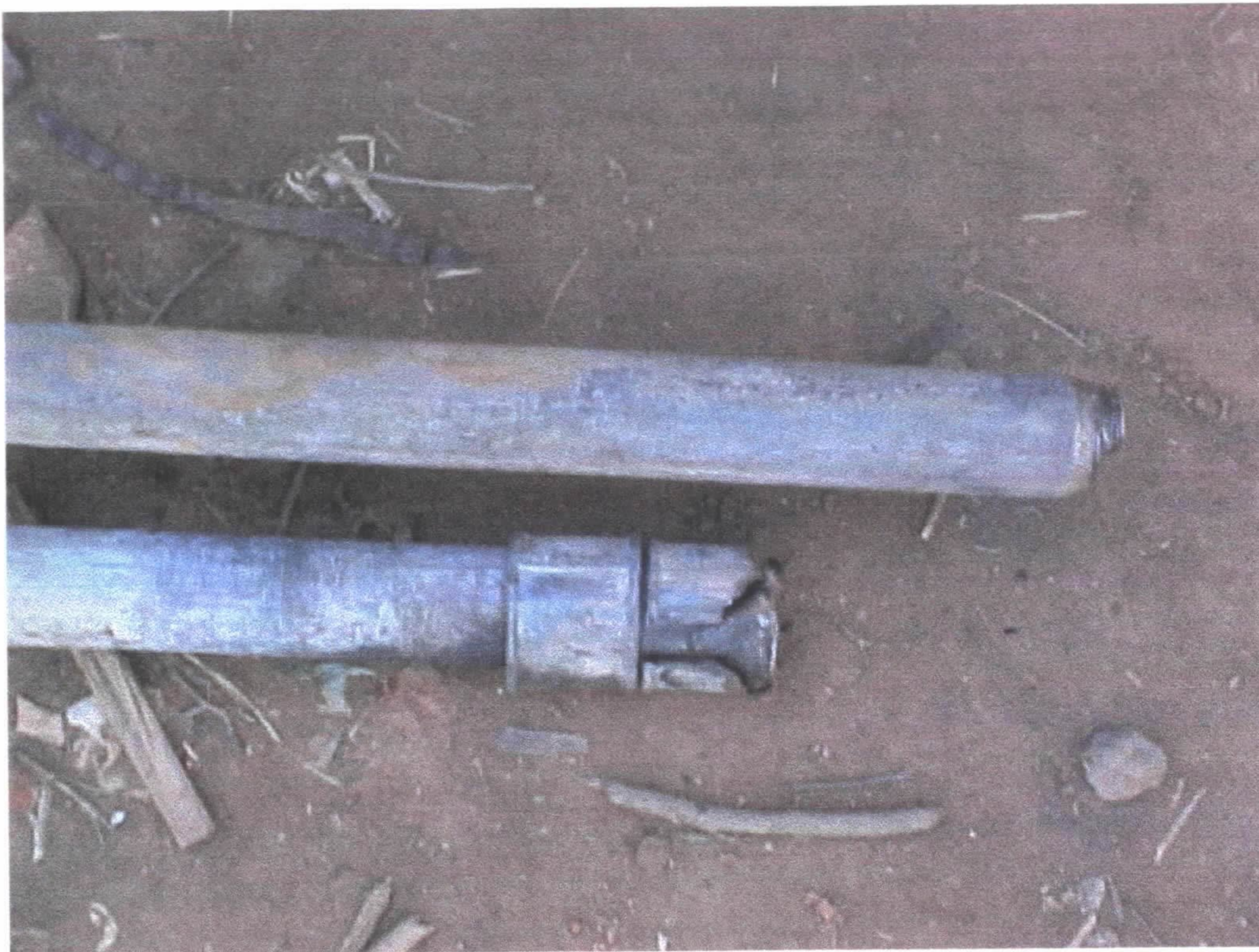
Foto 27 – Detalhe de tubo retorcido cortado/pescado pela sapata/comandos
