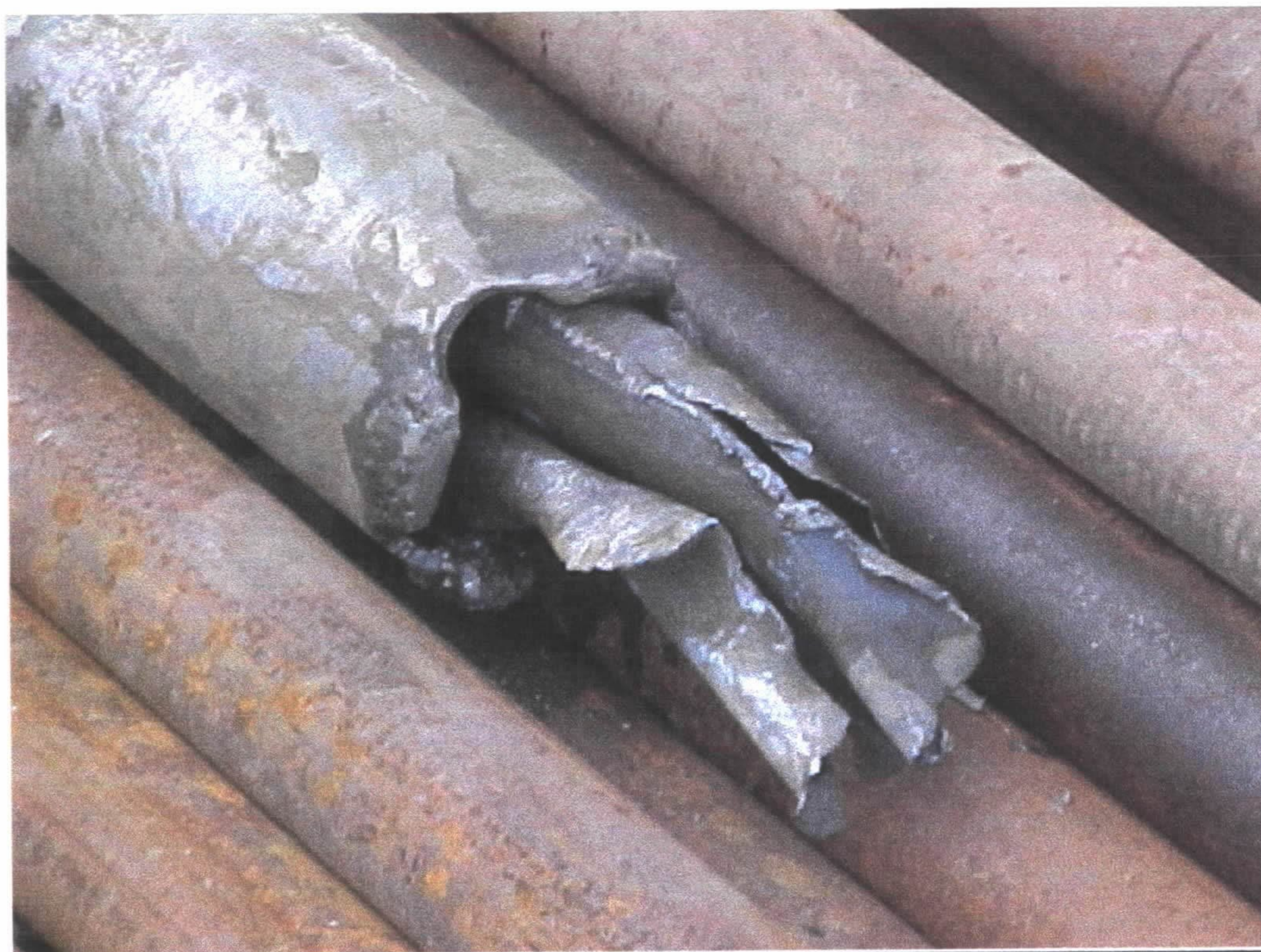
Foto 25 – Aspecto dos tubos cortados/pescados pela sapata (extração)
