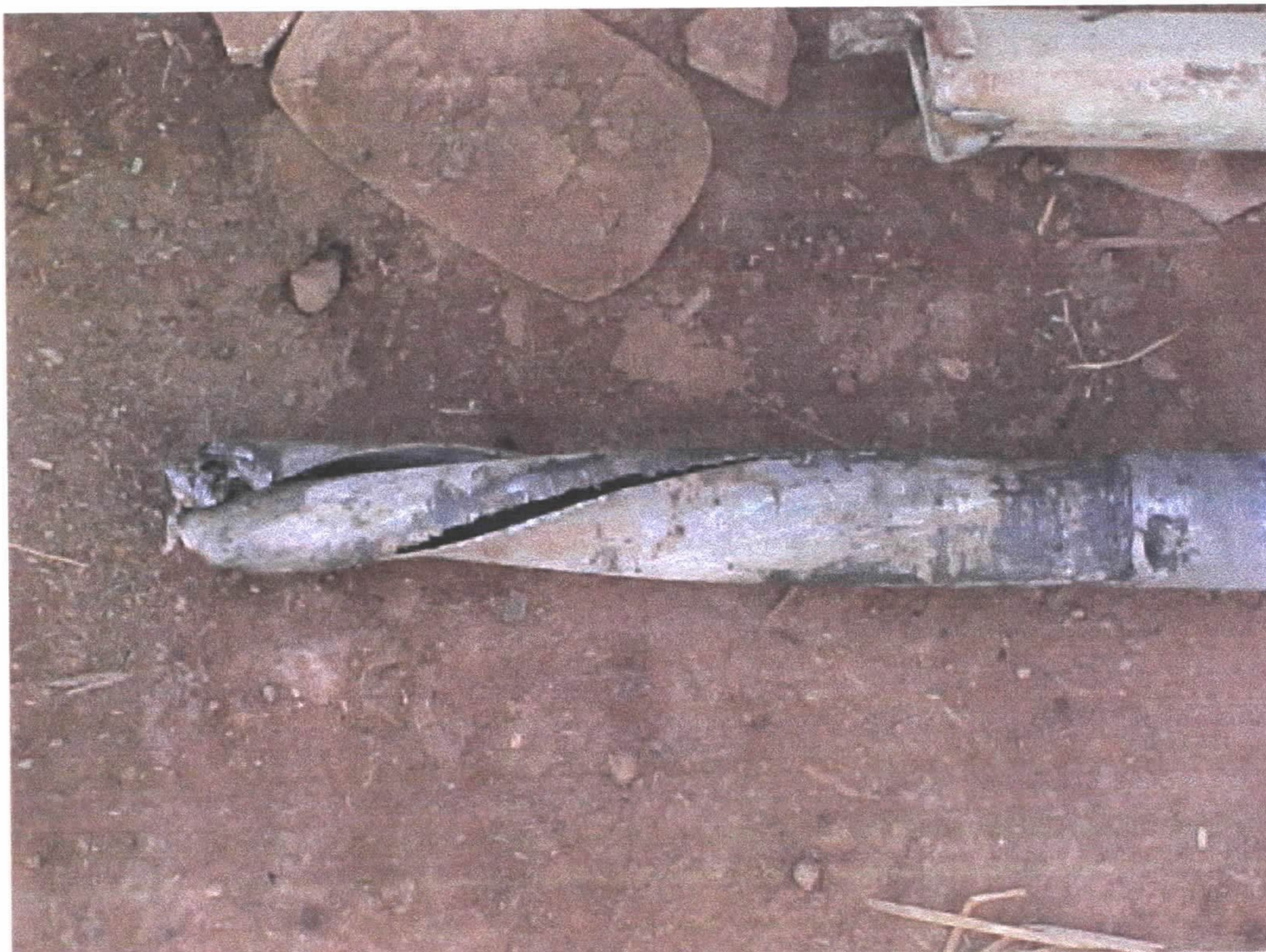
Foto 27 – Detalhe de tubo retorcido cortado/pescado pela sapata/comandos
