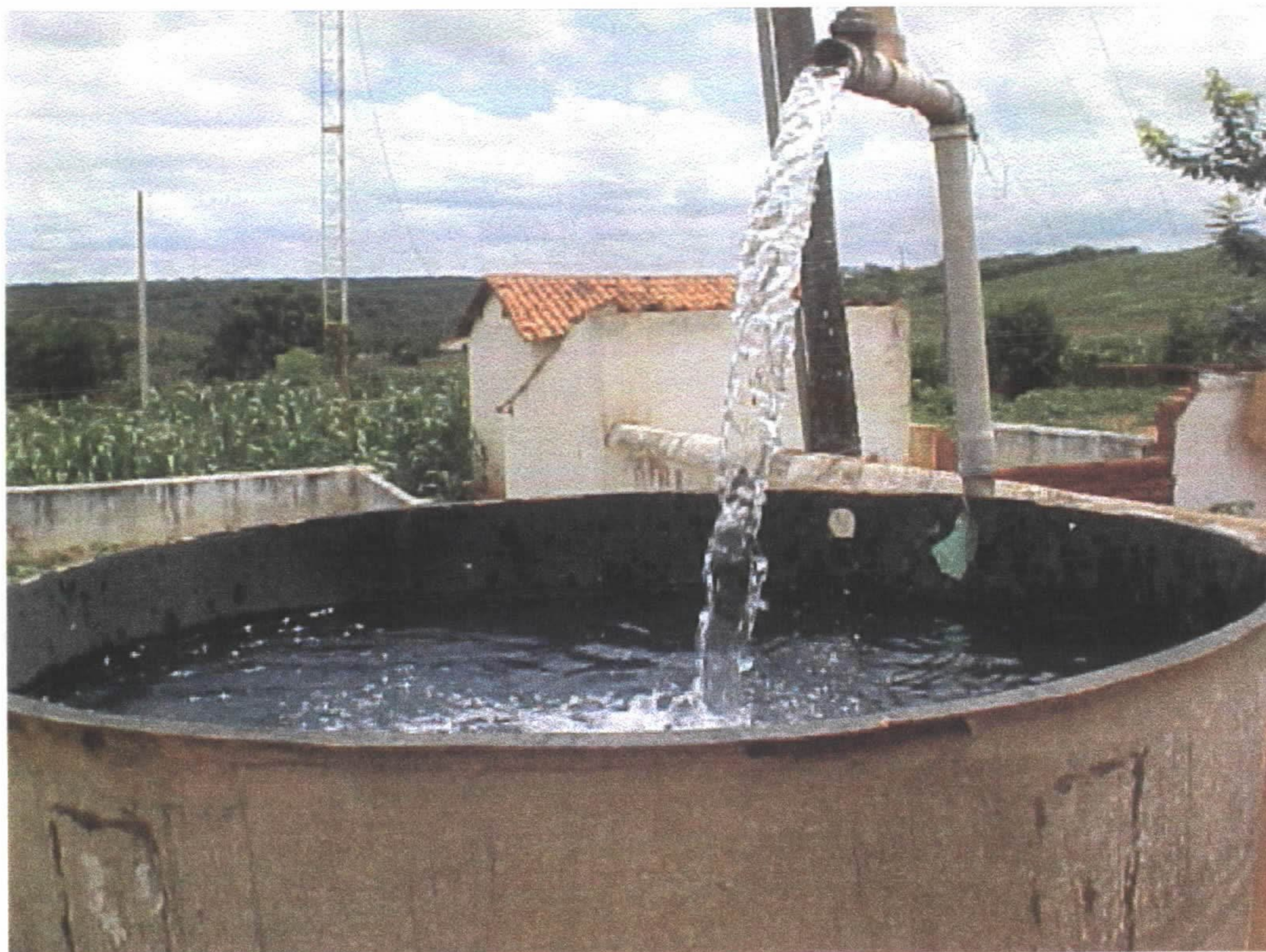
Foto 6 – Detalhe do bombeamento mostrando a recuperação da vazão inicial do poço
