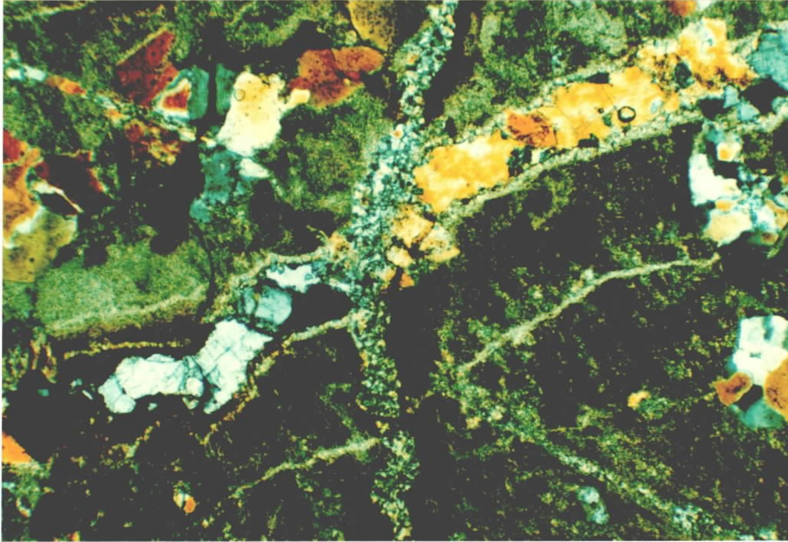
Fig. 22 - Granitóide alterado, contendo vênula de barita (com direção NE), cortada por vênula de quartzo microcristalino (N-S), talvez derivado de calcedônia(?). Amostra SMR-62. Material do Shaft. Garimpo Bom Jesus. LPX. 30x.
