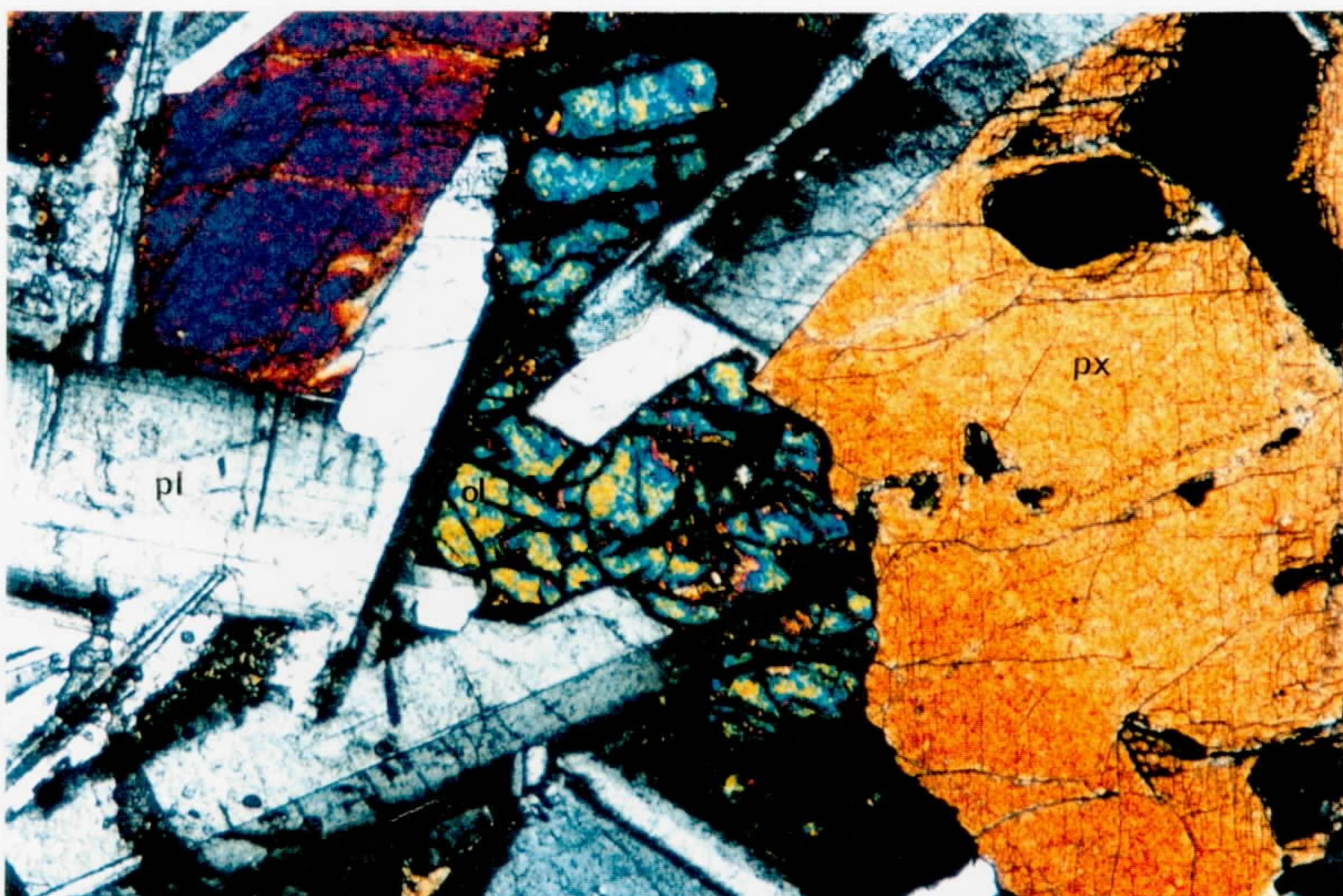
Fotomicrografia 9 - AD-15a - Aspecto da porção pegmatóide, mostrando olivina (ol), plagioclásio (pl) e piroxênio (px) em textura intergranular, de grão grosso (6mm a 1cm). LP, 25x.
