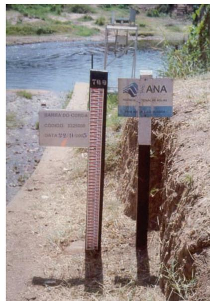
Régua Fluviométrica e Plataforma de Coleta de Dados (PCD), instalada na Estação Fluviométrica de Barra do Corda (MA).
