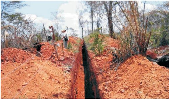
Aspecto de uma trincheira para coleta de amostras na pesquisa de carbonatitos da região de Planalto da Serra (MT). Projeto Avaliação de Rochas Calcárias e Fosfatadas para Insumos Agrícolas do Estado de Mato Grosso.
