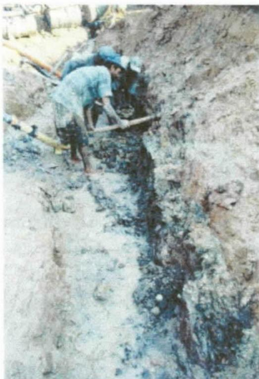
*Foto 19 - Aspecto típico das lavras do Garimpo do Mineiro, que desagregam filões de quartzo encaixados em saprólito de rochas granitóides, e os veios laterais de direções mais irregulares.*
