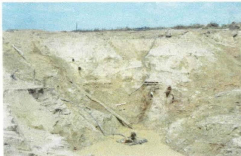
*Foto 11 - Escavação principal no Garimpo da Peteca, vista de NW para SE, desenvolvida em espesso manto de intemperismo. O garimpeiro está desmontando um veio de quartzo fraturado e oxidado, com altos teores de ouro. Ponto 9, localizado a noroeste de Matupá.*
