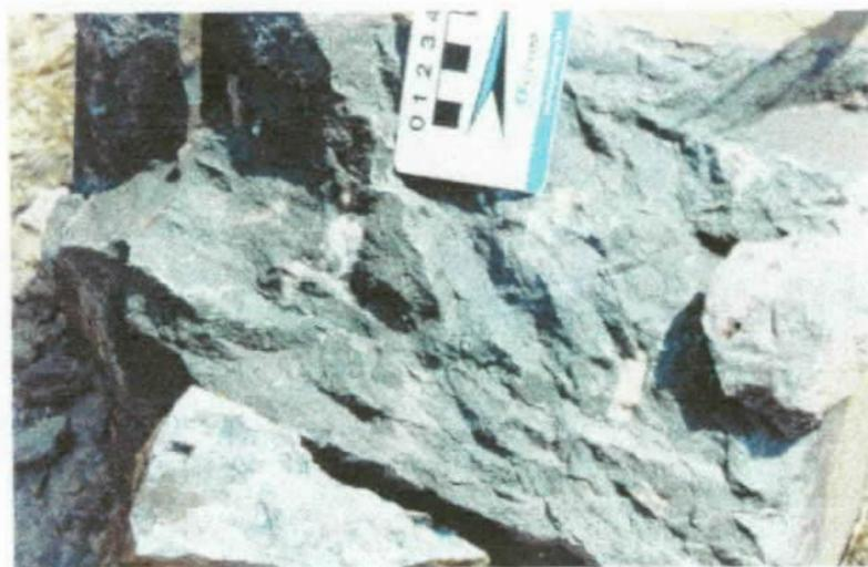
*Foto 9 - Bloco da rocha básica magnética, encaixante dos veios de quartzo mineralizados, retirados de shaft abandonado no Garimpo de Flor da Serra. Observar dois fragmentos de quartzo, contendo malaquita e pirita. Ponto 7, a leste de Flor da Serra.*
