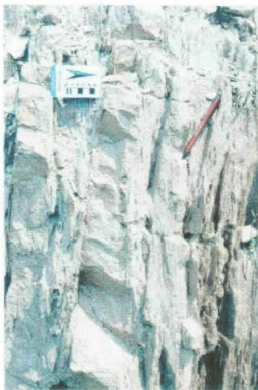
*Ponto 27 - Detalhe de afloramento dos sericita xistos miloníticos, verticalizados, onde se encaixam os veios de quartzo auríferos, no Garimpo do Fabinho. Na foto aparecem três destes veios, dois deles sustentando a escala, e o outro na ponta da lapiseira, todos orientados na direção N75E, subparalelos à foliação.*
