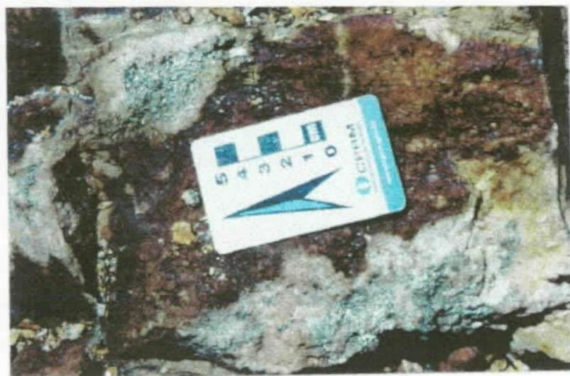
Foto 15 - Outro detalhe do granitóide mineralizado da Serrinha 2, muito fraturado e hidrotermalizado, com intensa piritização.
