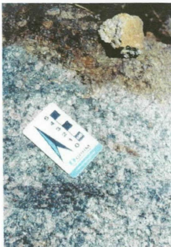
Foto 14 - Detalhe da textura porfírica do granitóide hidrotermalizado do depósito aurífero Serrinha 2, com venulações de quartzo e sulfetos (ao redor da escala).
