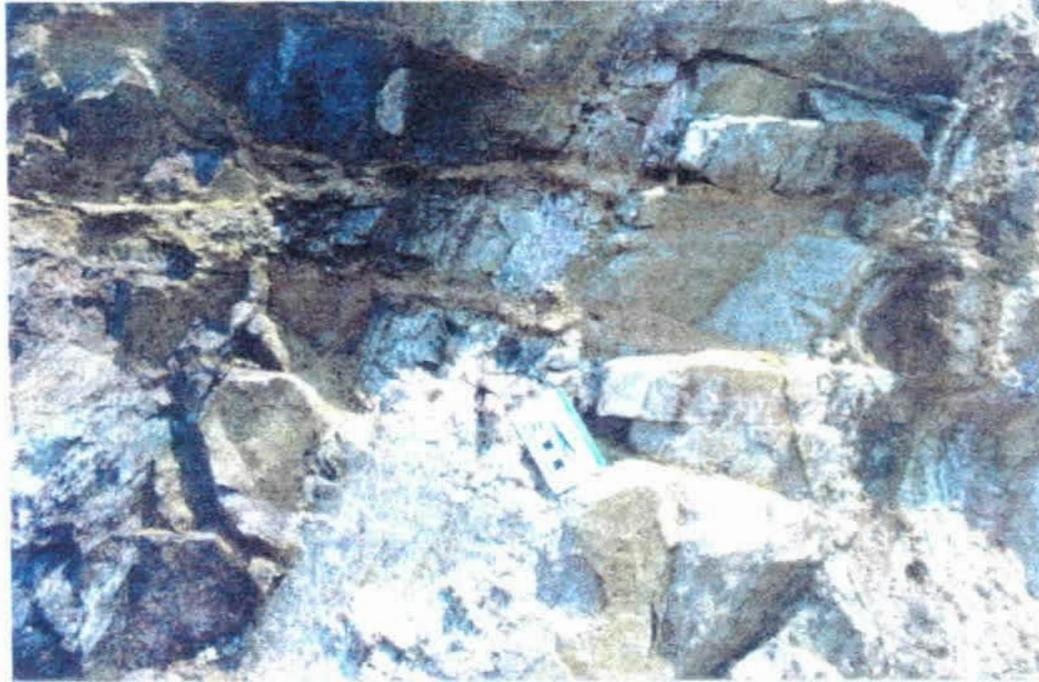
*Foto 6 - Frente de lavra em atividade no garimpo de Armando, desenvolvida em zonas silicificadas e oxidadas, e que constituem cristas destacadas no relevo plano. Observar também a foto da capa deste relatório. Ponto 5, a oeste de Matupá.*
